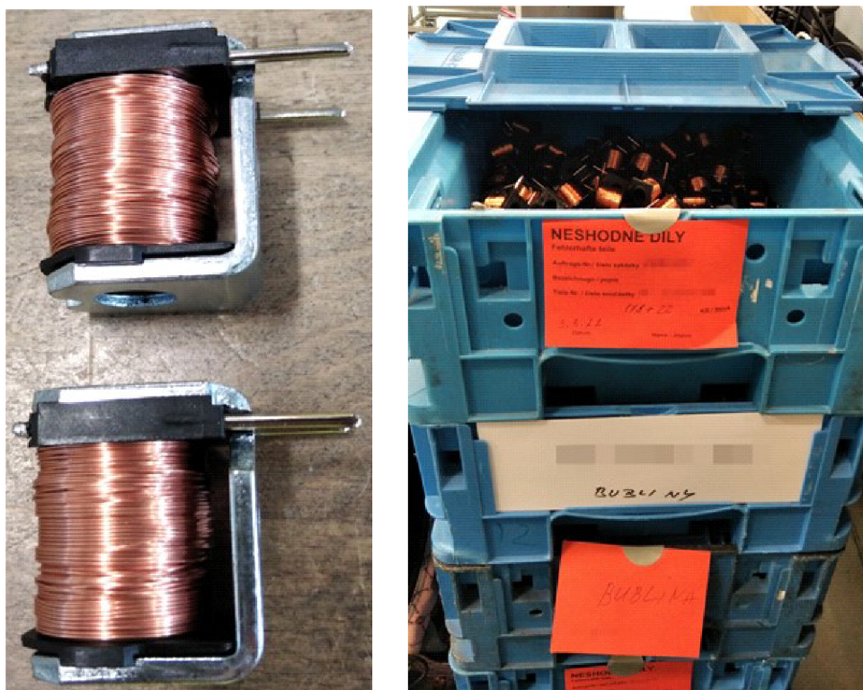
Obr. 24) OK vzorky v držáku (vlevo) a NOK kusy v KLT (vpravo)
