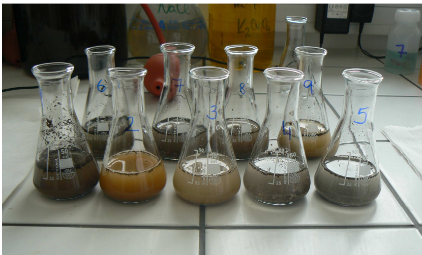
Obr. 4 Navážené vzorky půdního substrátu připravené k měření pH metrem
