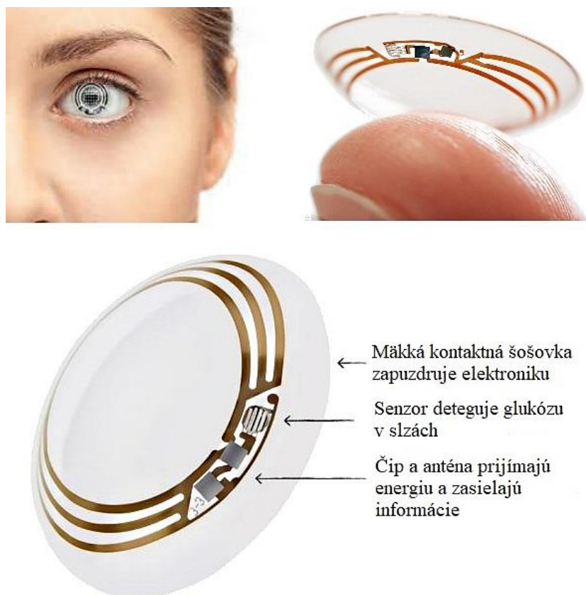
Obrázok 2: Prototypová koncepcia pre inteligentné kontaktné šošovky – nositeľná technológia slúžiaca na meranie glukózy v slzách pomocou malého bezdrôtového čipu a miniaturizovaného senzora vloženého medzi vrstvy mäkkého materiálu kontaktných šošoviek
