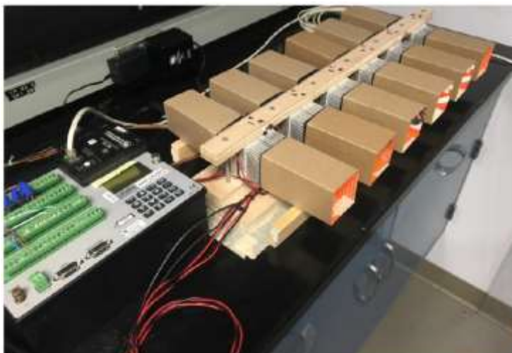
Obr. 4.18 Testovací aparatura k tepelnému cyklování termoelektrických modulů [30]
