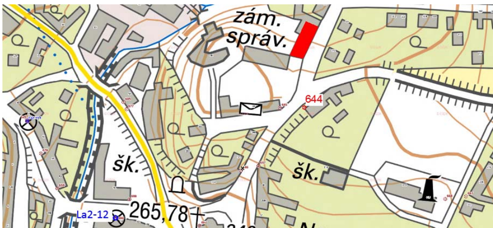
Obrázok č. 11: Poloha polohových a výškových bodov zdroj: http://geoportal.cuzk.cz/geoprohlizec/?wmcid=503
