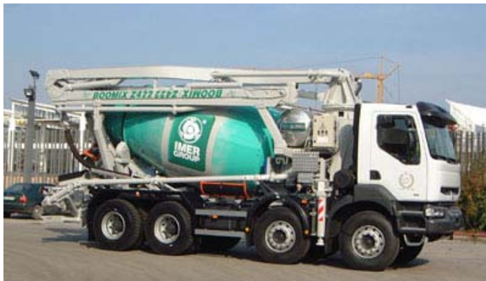
Obrázok č. 35: Domiešavač s pumpami na betón BOOMIX Z422
