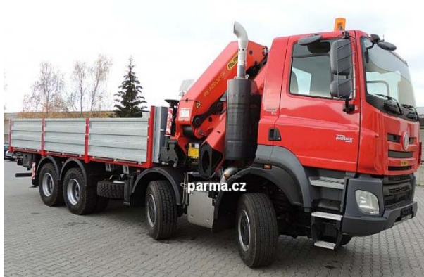
Obrázok č. 32: Nákladný automobil Tatra Phoenix T 158 s hydraulickou rukou
