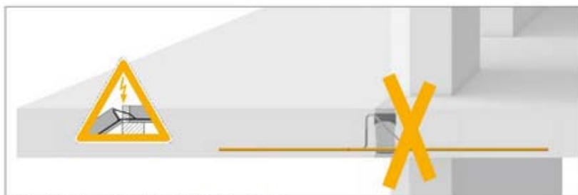
Chybné zabudování prvku Schöck Isokorb® typ K. Tažený prut je dole
