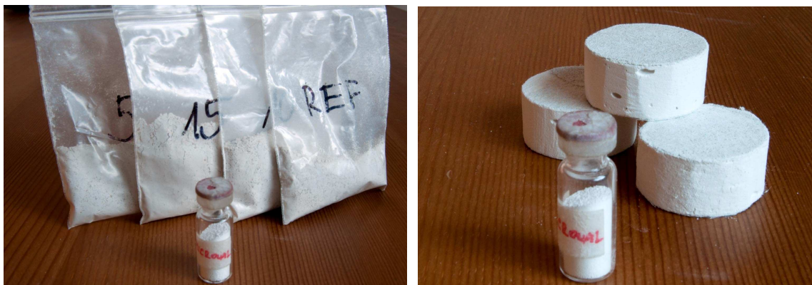
Obr. 33. Prášková forma (vlevo) Micronalu ® PCM a ztuhlá forma (vpravo) Micronalu ® PCM.
