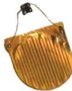
Obr. 18. Zdroj tepla izolovaný Kaptonem ® .
