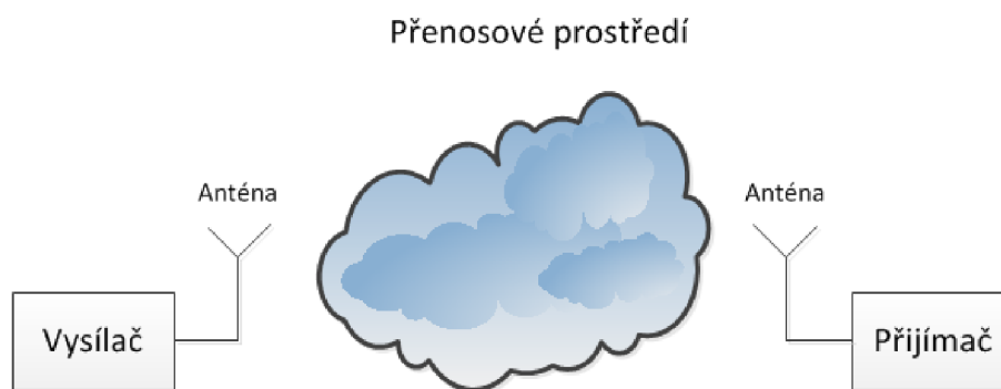
Obr. 2.1: Obecný princip rádiového přenosu.
