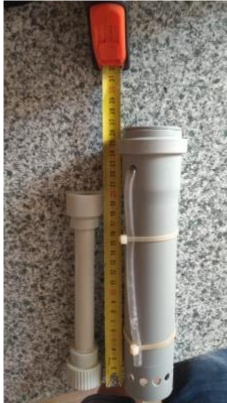
Obr. č. 25: Vnitřní a vnější trubka automatického sifonu (vlastní foto)
