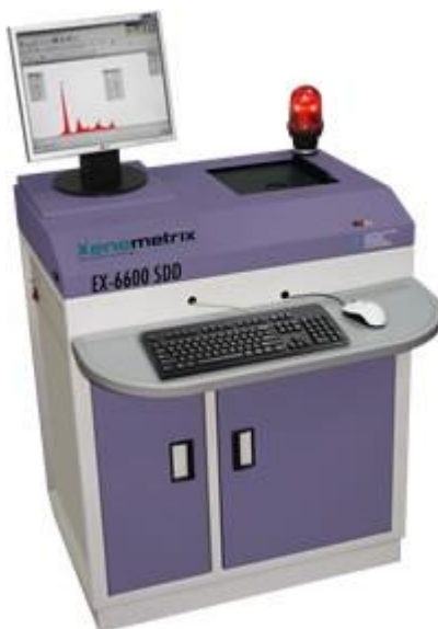
Obrázek 10: EDXRF spektrometr od firmy XENEMATRICS, který je na Fakultě Chemické VUT v Brně [33].
