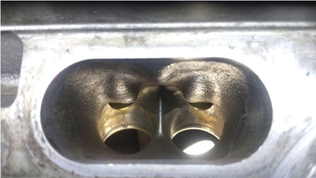
Obr. 34 Hrana mezi sacími ventily - před úpravou
