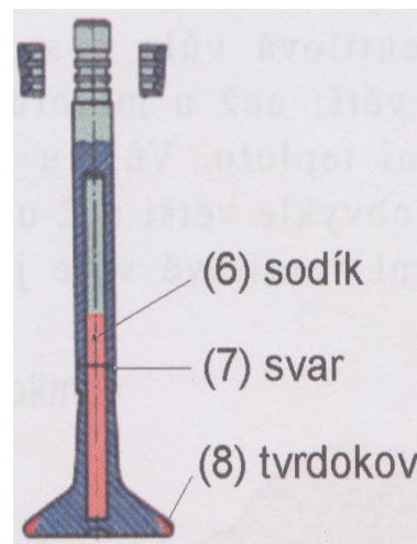
Obr. 17 Výfukový ventil chlazený sodíkem [9]
