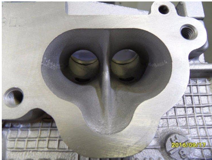
Obr. 30 Sací kanál před úpravou [25]
