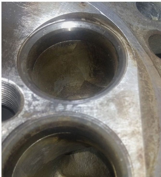
Obr. 40 Kritické místo kolem sedla ventilu - před úpravou
