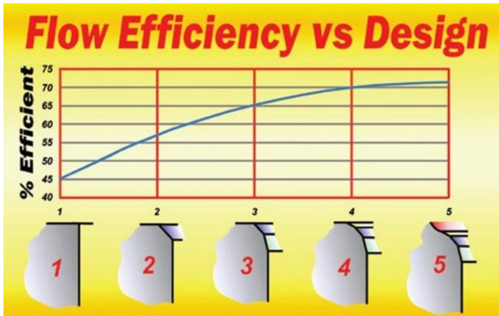
Obr. 27 Závislost tvaru sedla na plnicí účinnosti [14]
