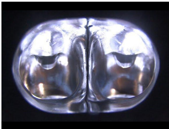
Obr. 19 Zrcadlový povrch kanálu [18]
