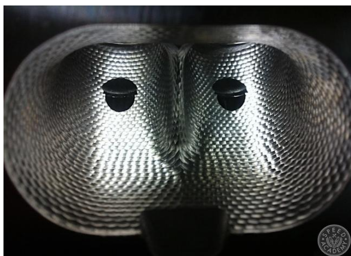
Obr. 20 Sací kanál s povrchem golfového míčku [16]
