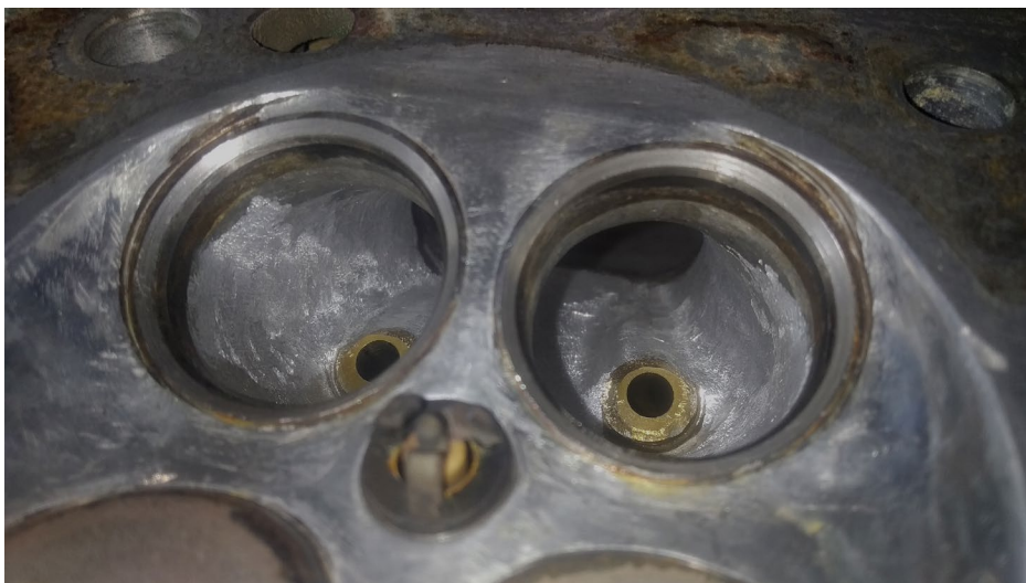
Obr. 39 Přejíčovové hrany v sacím kanálu - po úpravě
