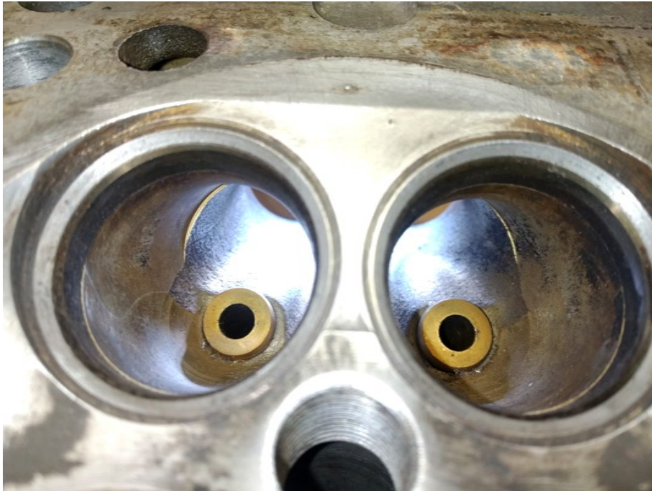
Obr. 38 Přejíčovové hrany v sacím kanálu - před úpravou
