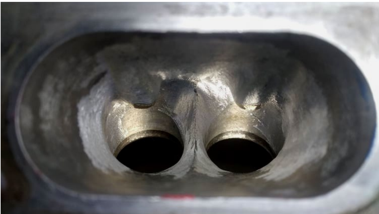
Obr. 35 Hrana (břit) mezi sacími ventily - po úpravě
