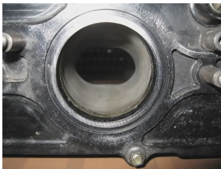
Obr. 10 Šoupátková škrticí klapka - plně otevřena [8]
