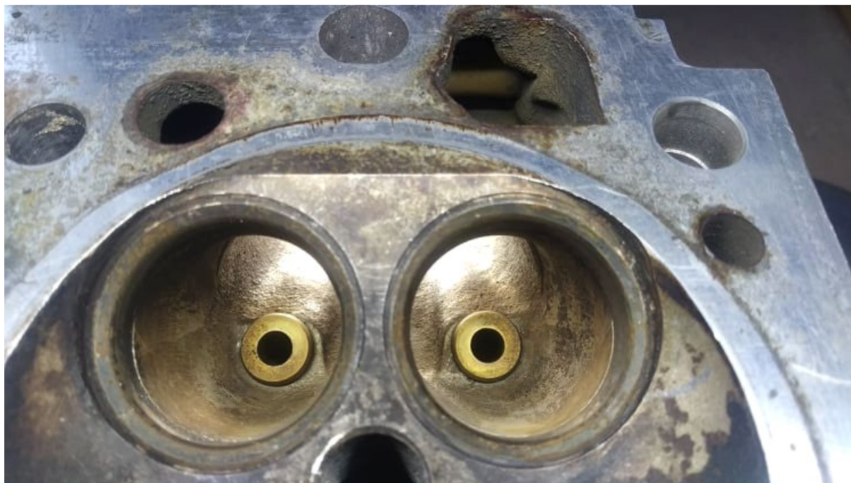
Obr. 36 Kritické místo kolem vodítek ventilů - před úpravou
