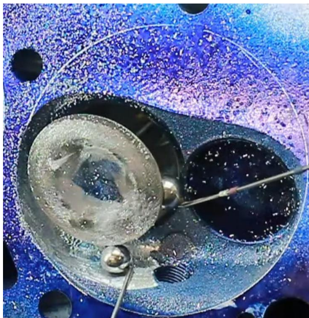
Obr. 28 Portování spalovacího prostoru [21]
