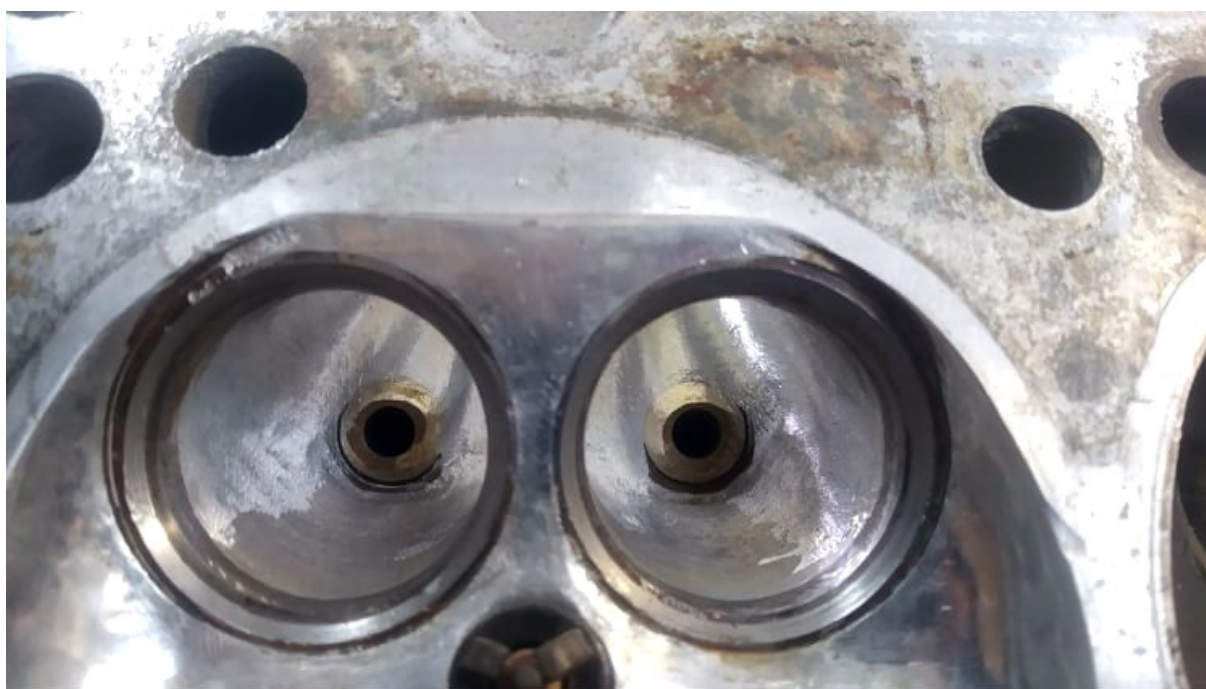
Obr. 37 Kritické místo kolem vodítek ventilů - po úpravě
