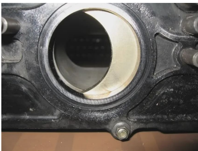
Obr. 9 Šoupátková škrticí klapka - přechodový režim [8]
