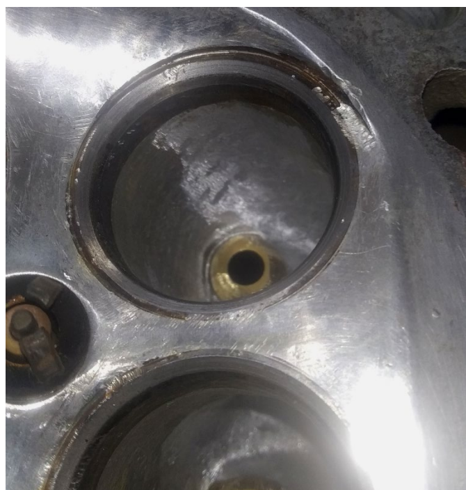
Obr. 41 Kritické místo kolem sedla ventilu - po úpravě
