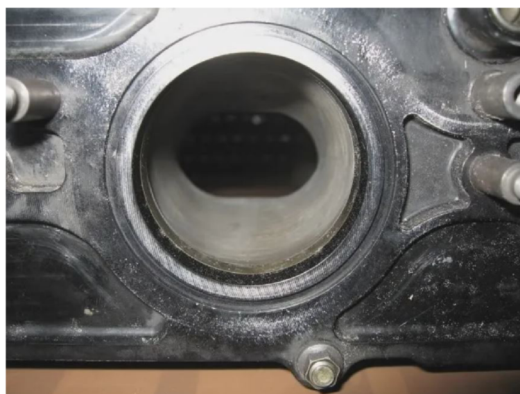
Obr. 10 Šoupátková škrticí klapka - plně otevřena [8]
