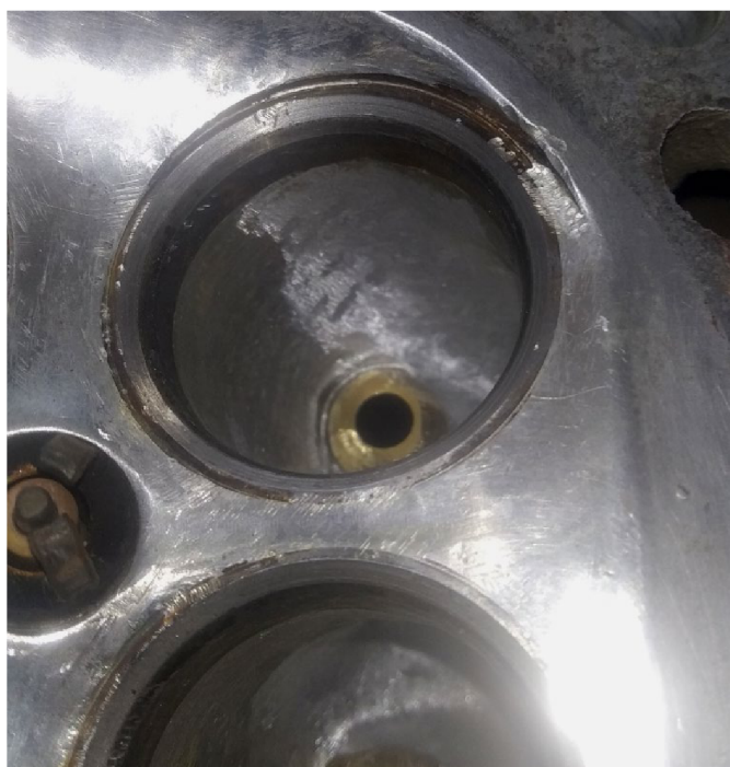
Obr. 41 Kritické místo kolem sedla ventilu - po úpravě
