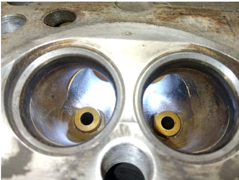
Obr. 38 Přechodové hrany v sacím kanálu - před úpravou
