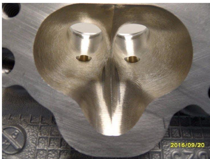
Obr. 31 Sací kanál po úpravě [25]
