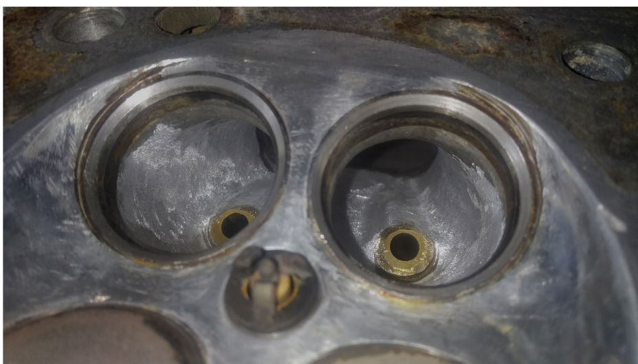
Obr. 39 Přechodové hrany v sacím kanálu - po úpravě
