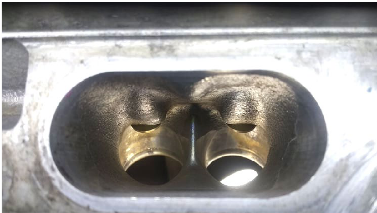
Obr. 34 Hrana mezi sacími ventily - před úpravou
