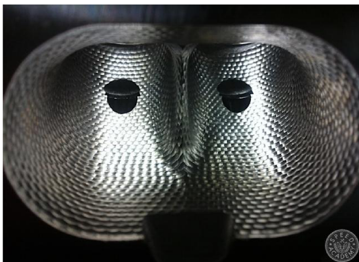
Obr. 20 Sací kanál s povrchem golfového míčku [16]
