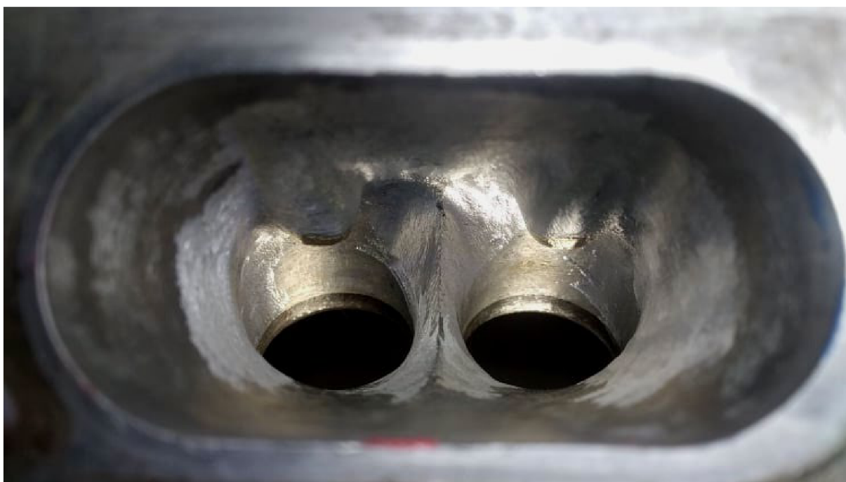
Obr. 35 Hrana (břit) mezi sacími ventily - po úpravě
