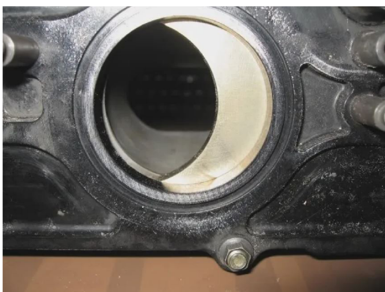
Obr. 9 Šoupátková škrticí klapka - přechodový režim [8]
