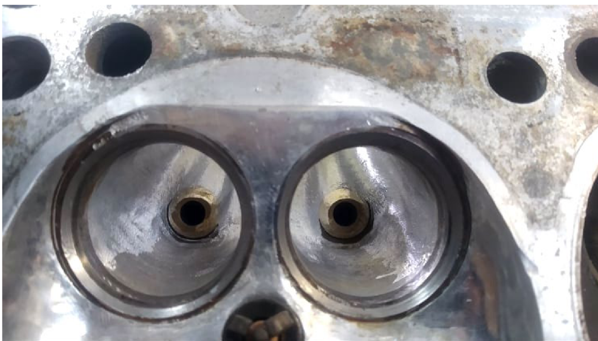
Obr. 37 Kritické místo kolem vodítek ventilů - po úpravě
