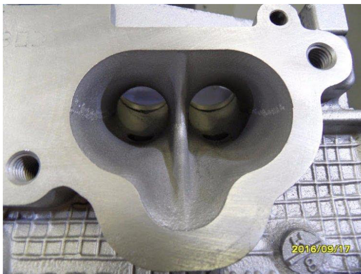
Obr. 30 Sací kanál před úpravou [25]
