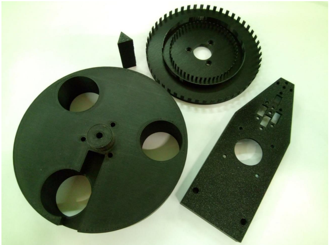
Obrázek 36: Vytisknuté díly na 3D tiskárně
