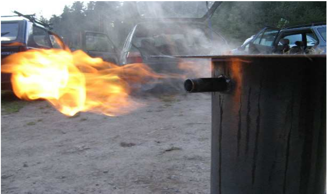
Obrázek 6.2-5 Generování dřevoplynu. [autor]
