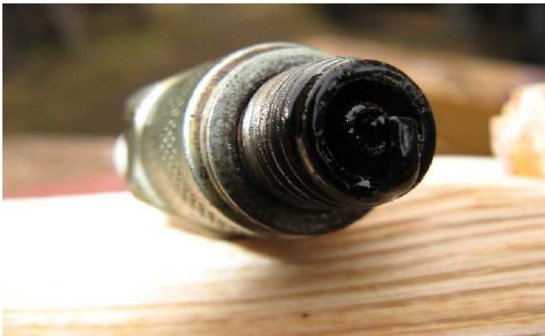
Obrázek 6.5-1 Zapalovací svíčka. [autor]
