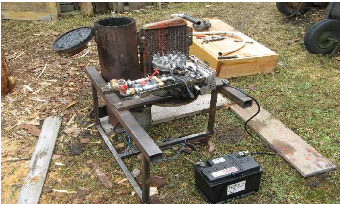
Obrázek 6.11-1 Sestavení generátoru plynu a motoru. [autor]
