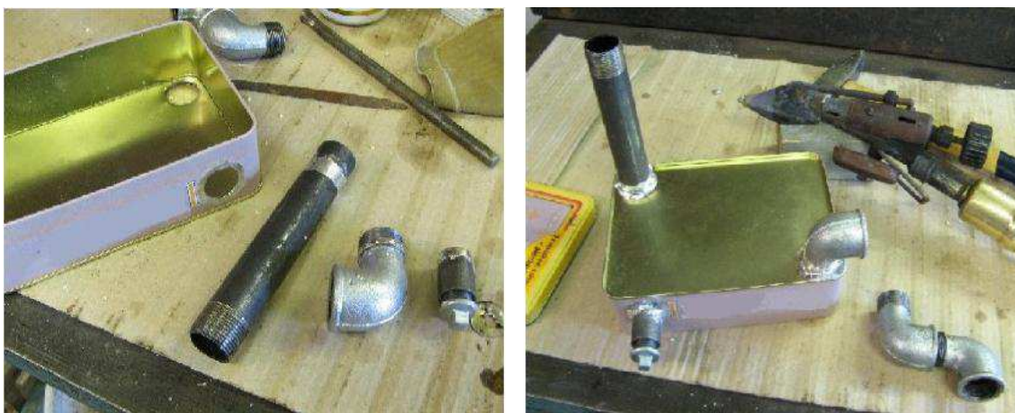
Obrázek 6.14-1 Konstruování filtru dehtu. [autor]
