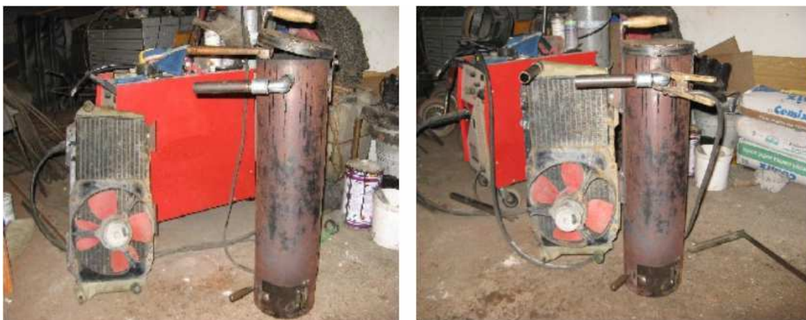
Obrázek 6.7-1 Chladič plynu. [autor]
