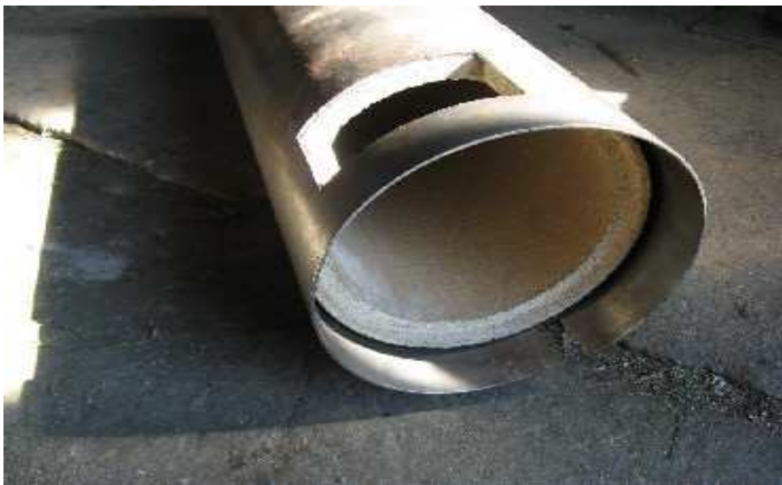
Obrázek 6.2-2 Oplechování generátoru. [autor]
