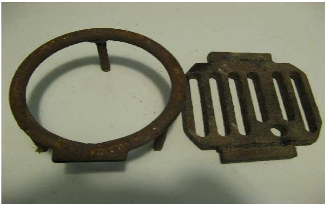
Obrázek 6.2-3 Rošt generátoru. [autor]
