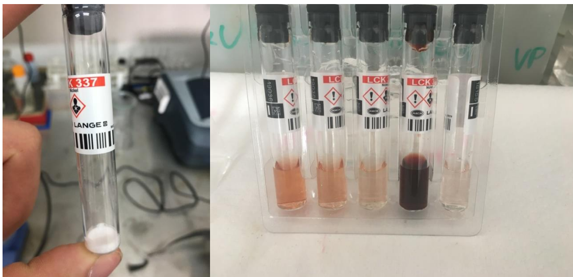
Obr. 8 Vlevo: Připravená kyveta s práškovou reagentí, Vpravo: Kyvety po přidání vzorků vody.
