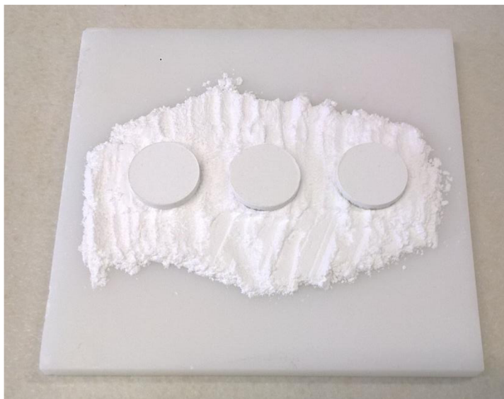
Obr. 13: BCZT disky na ZrO_2 podložce připravené ke slinutí
