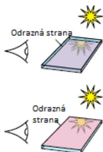
Obr. 3. 5: Pozorování reflexe od dichroického zrcadla. Převzato z [5].
