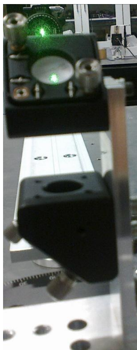
Obr. 3. 21: Držáky dielektrických a kovových zrcadel připevněné ke konstrukci
