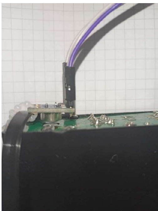
Obrázek 15 detail instalace teplotního čidla. Zdroj: vlastní zpracování
