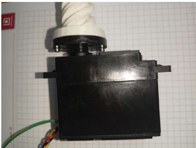
Obrázek 4 Servo HS-805bb+. Zdroj: vlastní zpracování
