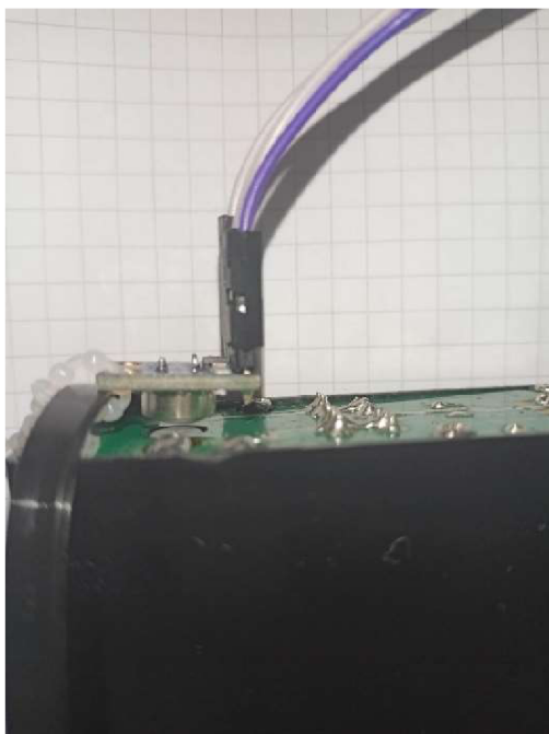
Obrázek 15 detail instalace teplotního čidla. Zdroj: vlastní zpracování
