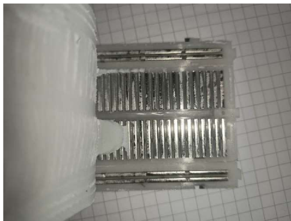
Obrázek 2 Nepájivé pole -vnitřní uspořádání. Zdroj: vlastní zpracování
