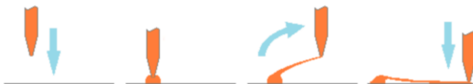
Obr. 2.14: Robotický postup tvorby vlákna metodou tažení [42]
