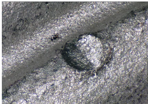
Obr. 3.4: Kontrola defektů závitů [51]
