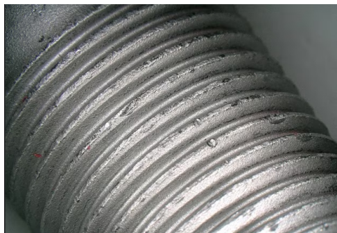
Obr. 3.4: Kontrola defektů závitů [51]
