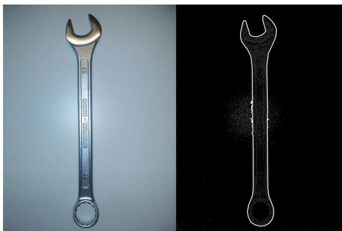
Obr. 2.2: Znáznornění detekce kontur[10]
