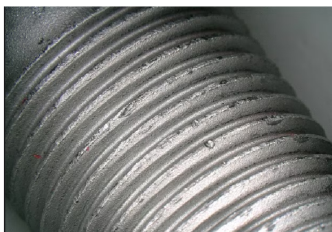
Obr. 3.4: Kontrola defektů závitů [51]
