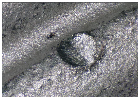
Obr. 3.4: Kontrola defektů závitů [51]
