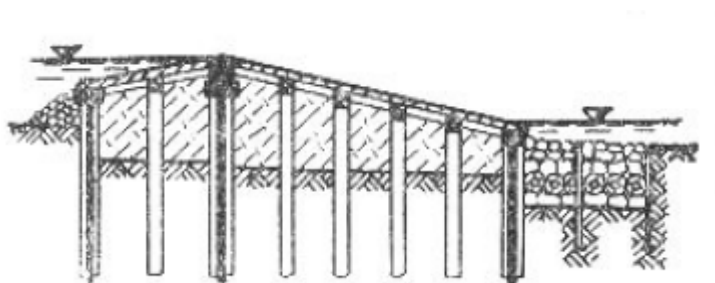
Obrázek 9 dřevěný jez (Havlík, 2017)
