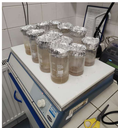
Obr. 19: varné lázně pro odpaření vzorku. Zdroj: foto archiv autora
