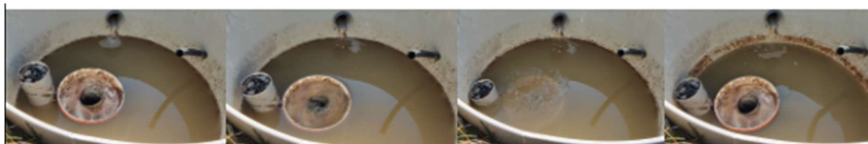
Obr. 11: fotosekvence vypouštění dávky odpadní vody z pulzní šachty do kořenového filtru, zdroj archiv autora (2023)
