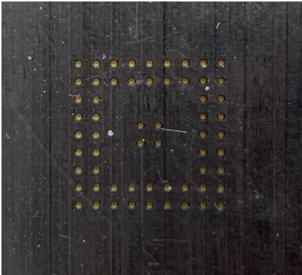
Obrázek 5: Otvory BGA na šabloně překryvají odpovídající BGA otvory na DPS
