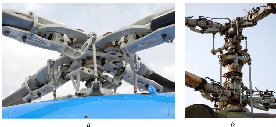
Obrázek 2.1.1 – Řízení nosným rotorem, a – jednorotorový vrtulník Bell-429, b – koaxiální vrtulník Kamov Ka-27 [3], [9]
