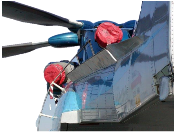
Obrázek 5.1.1 – Aerodynamický hřeben na vrtulníku EH-101
