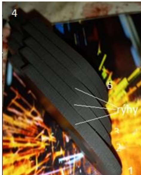
Obr. 90 Detailní pohled na řezanou plochu vzorků. Vzorky: 1-řezaný při 3000 mm/min, 2-řezaný při 2000 mm/min, 3-řezaný při 1000 mm/min, 4-řezaný při 600 mm/min, 5-řezaný při 300 mm/min.
