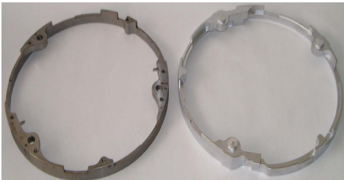
Obr. 2.4 Náhrada součásti vyráběné třískovým obráběním odlitkem litým metodou vytavitelného modelu [2]
