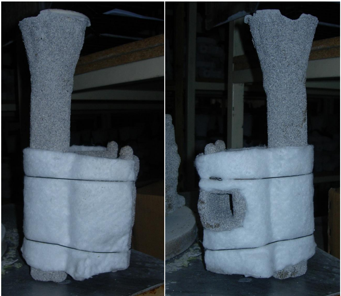
Obr. 3.63 Varianta 1 – forma před vložením do žíhací pece
