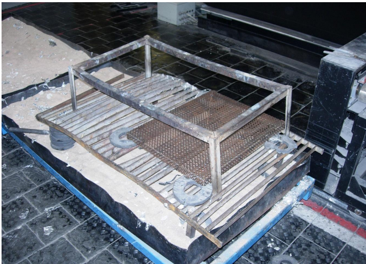
Obr. 3.65 Improvizovaný licí rošt
