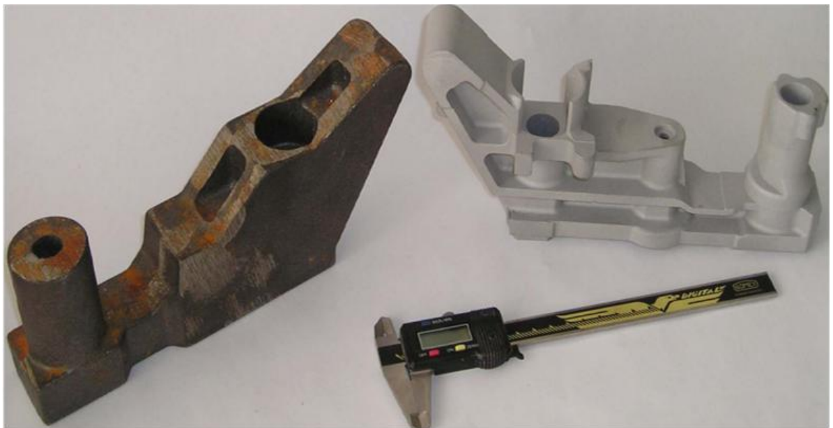
Obr. 2.3 Náhrada litinového odlitku litého do písku odlitkem z hliníkové slitiny litým metodou vytavitelného modelu [2]
