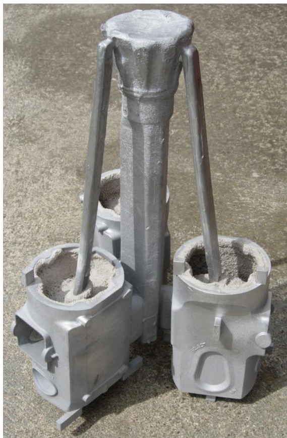
Obr. 3.70 Odlitý stroměček varianty 5
