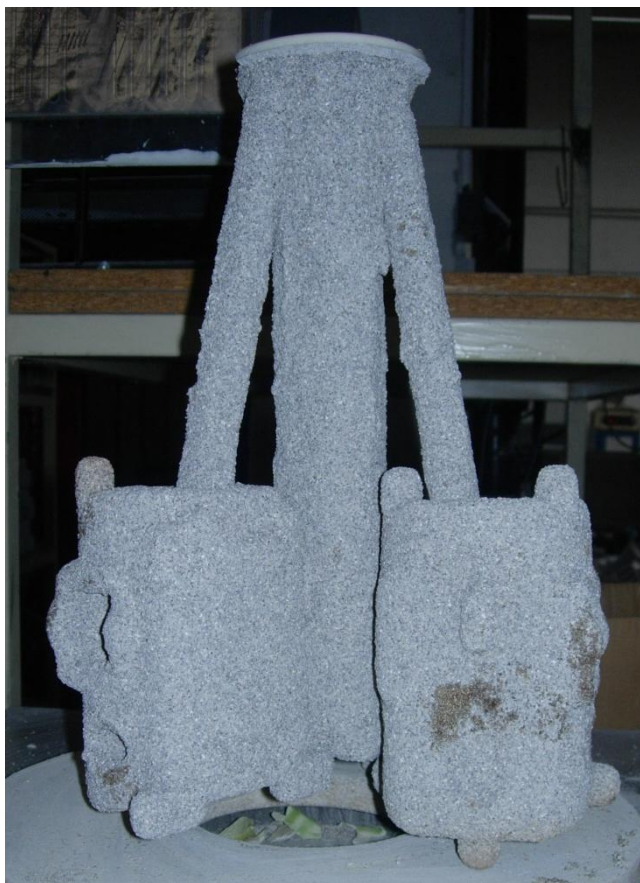
Obr. 3.64 Varianta 5 – skořepinová forma
