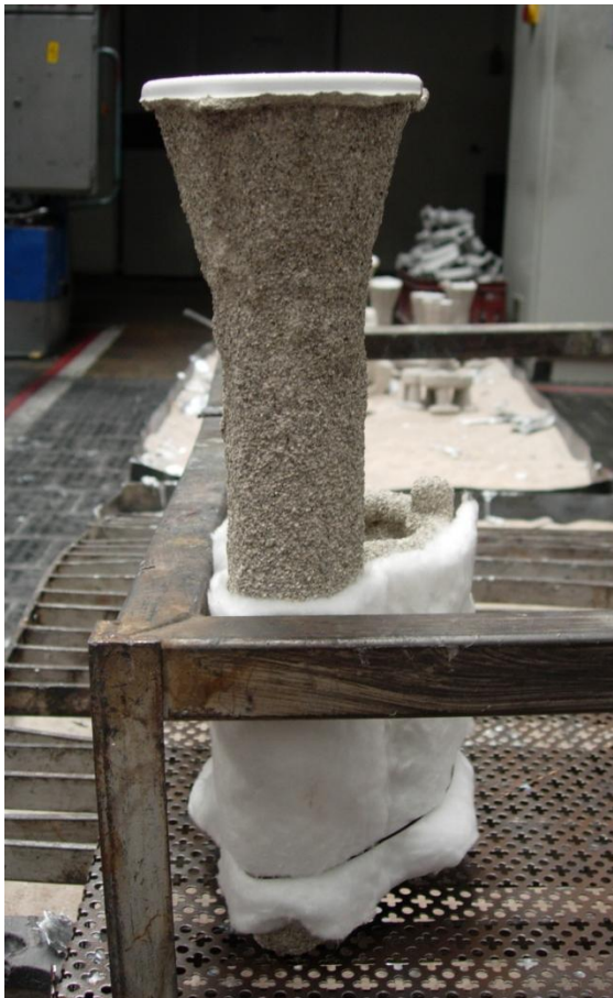
Obr. 3.67 Ustavení formy na licím roštu
