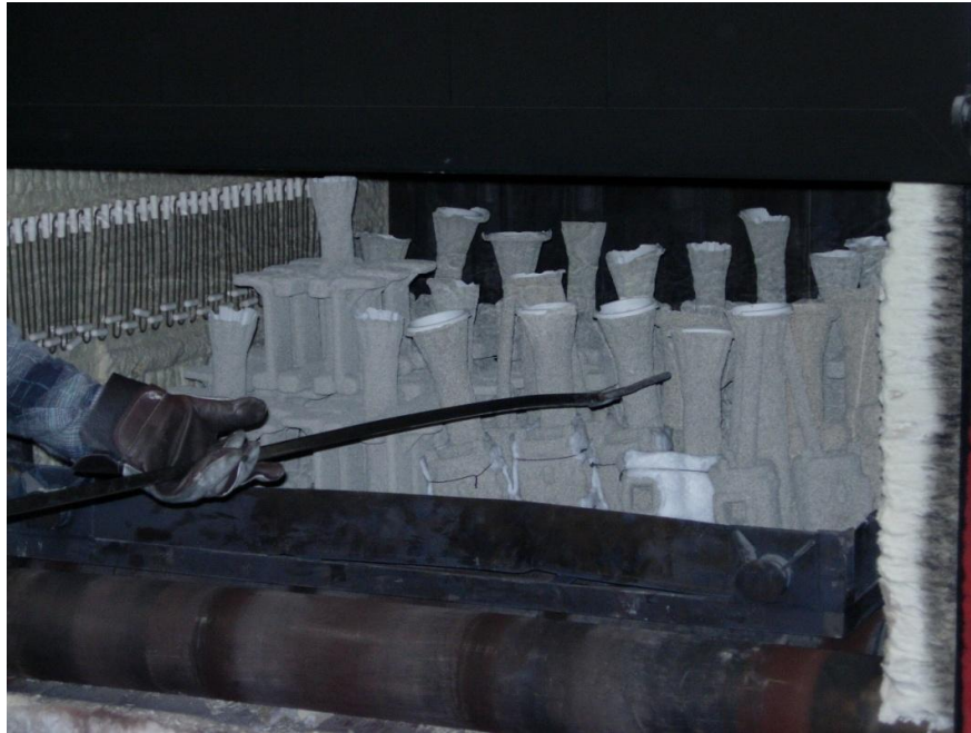
Obr. 3.66 Skořepinové formy v žíhací peci
