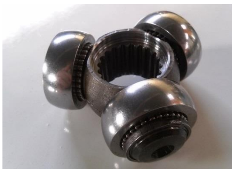
Obr. 51 Tripoidní kloub od firmy Drexler-Motorsport GmbH
