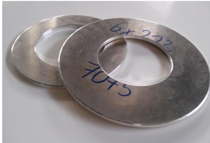
Obr. 37 Polotovary pro výrobu řetězových rozet
