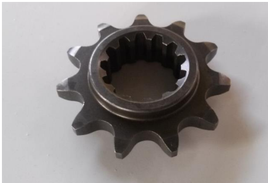
Obr. 27 Vyrobený pastorek s 11 zuby
