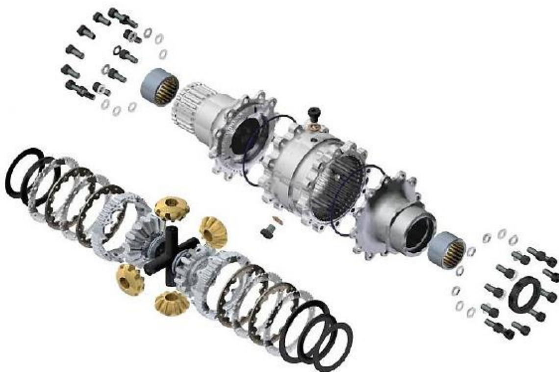
Obr. 30 Diferenciál Drexler LSD Formula Student 2010 v „rozpadu“
