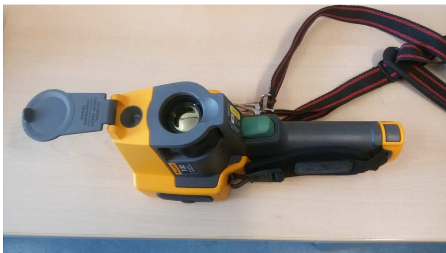
Příloha 20 Infračervená kamera FLUKE Ti32 (Zdroj: Autor, 2015)
