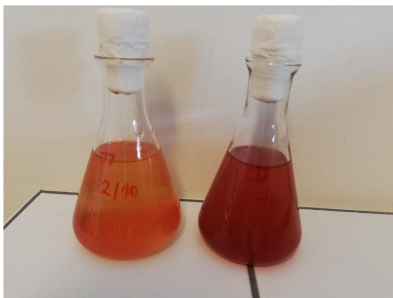
Obrázok 13: Erlenmeyrové banky 100 ml v čase kultivácie 72 h. Vľavo, kultivácia za tmy. Vpravo kultivácia za svetla
