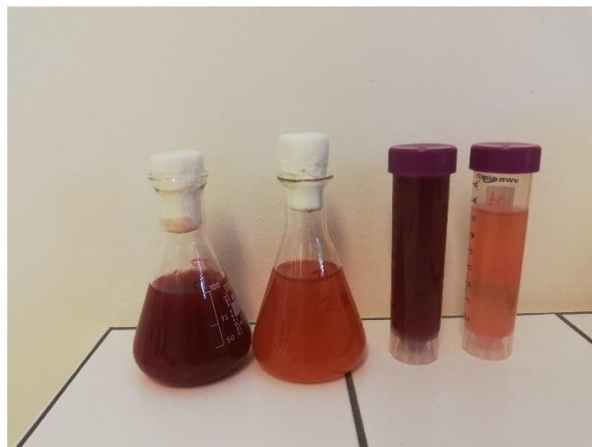
Obrázok 15: Porovnanie zafarbenia v časoch kultivácie: zľava 96, 120 a 144 hodín. Intenzívnejšie zafarbené média odpovedajú kultivácií za svetla, svetlejšie za tmy
