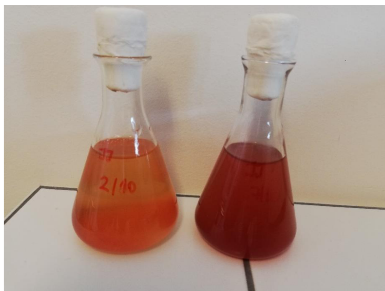
Obrázok 13: Erlenmeyrové banky 100 ml v čase kultivácie 72 h. Vľavo, kultivácia za tmy. Vpravo kultivácia za svetla
