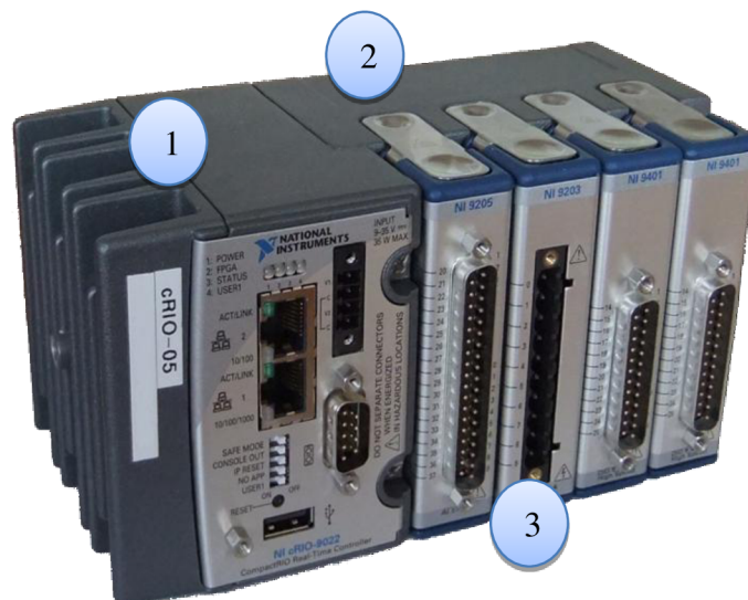
Obr. 13 NI cRio: 1) Kontrolér 2) Chassis 3) I/O Moduly (zleva Slot 1 – 4)
