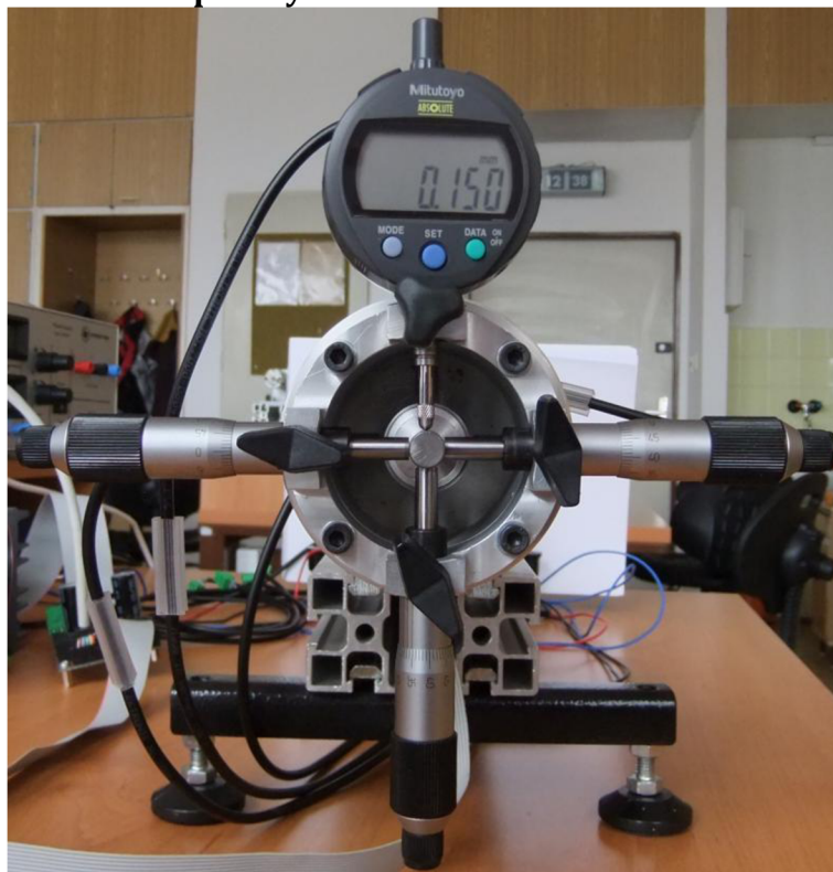
Obrázek 5-1 Postup kalibrace snímačů polohy
