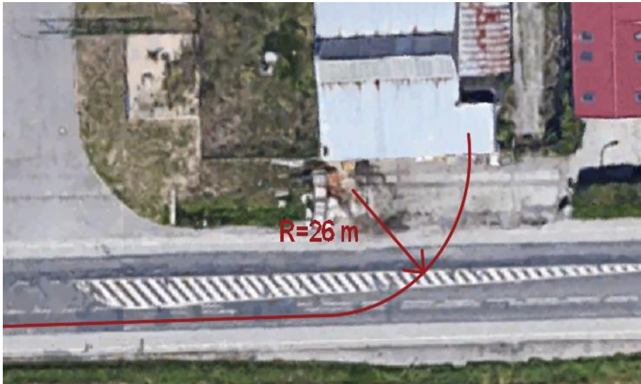
Obrázek 37: Levotočivá odbočka na staveniště (upraveno autorem) [2]
