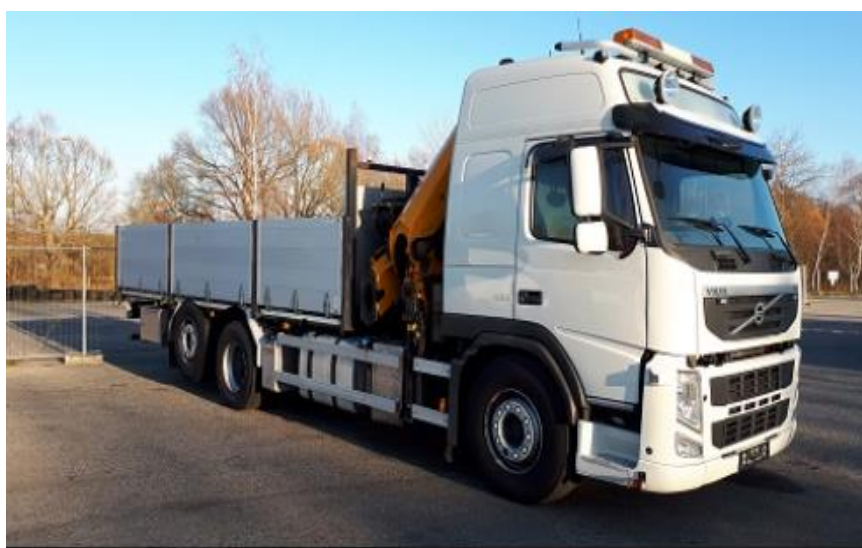
Obrázek 79: Valník s hydraulickou rukou VOLVO FH460 [21]
