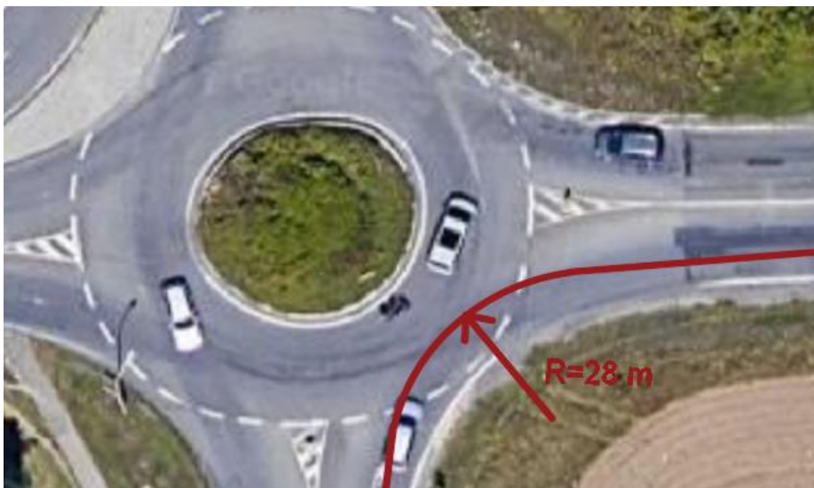
Obrázek 26: Přijezd z ulice Bedřichova, odbočení na silnici číslo 430 směr na Vyškov (upraveno autorem) [2]
