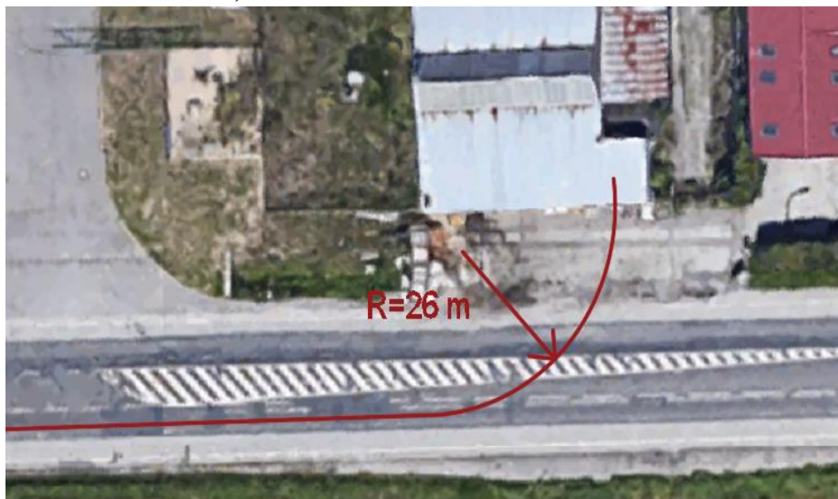
Obrázek 50: Odbočka vlevo na staveniště (upraveno autorem) [2]
