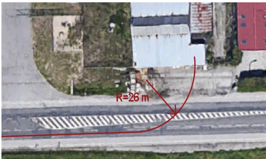
Obrázek 15: Levotočivá odbočka na staveniště (upraveno autorem) [2]
