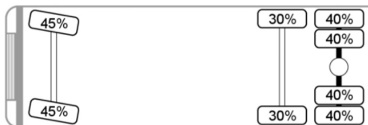
Obrázek 75: Natáčení a pohon náprav tahače MAN D38 [18]
