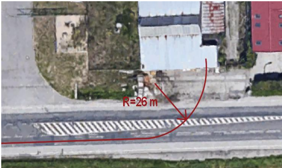
Obrázek 27: Levotočivá odbočka na staveniště (upraveno autorem) [2]
