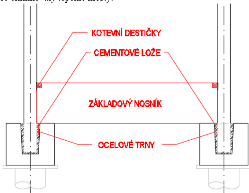
Obrázek 117: Osazení základového nosníku (vytvořeno autorem)
