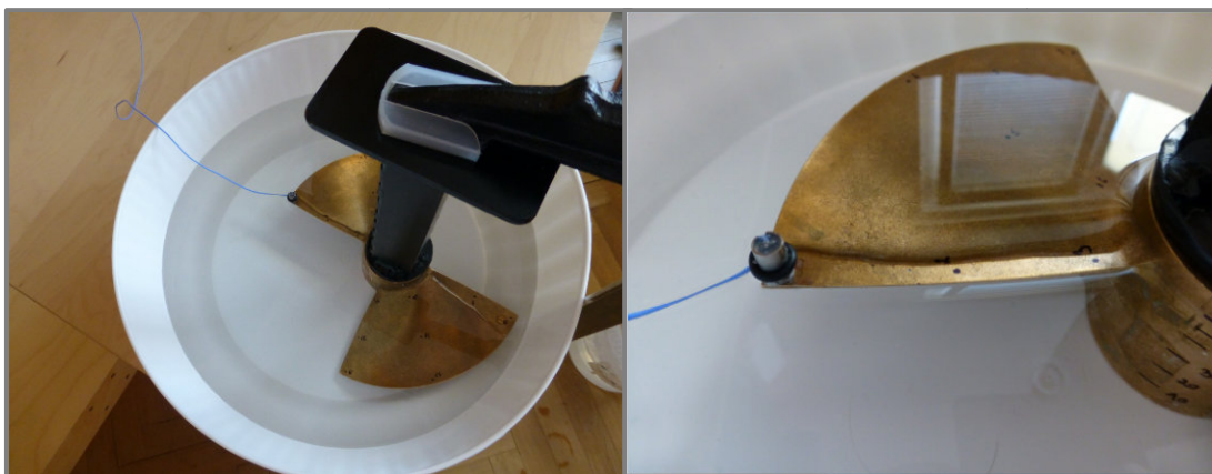
Obr. 6-20 Obežné koleso maximálne ponorené vo vode
