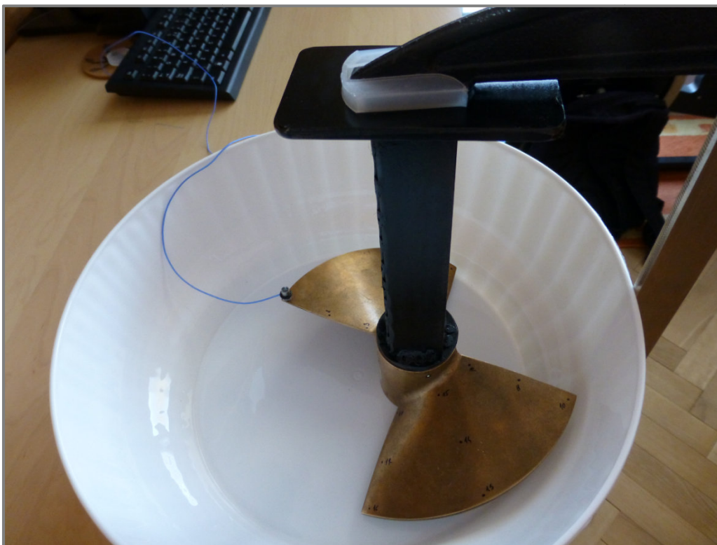
Obr. 6-18 Obežné koleso viazané k základnému rámu pri experimente
