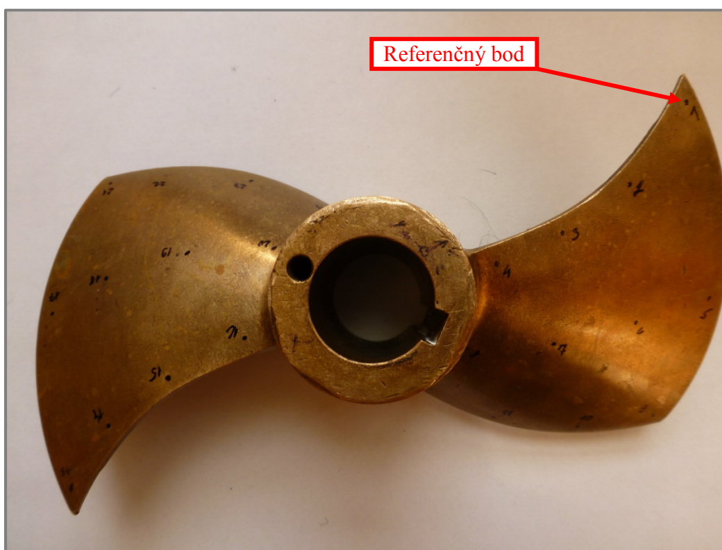
Obr. 6-1 Sieť bodov pre EMA na Lopatke č.2
