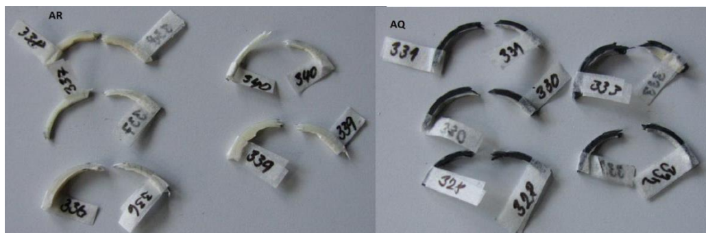
Obr. 3.3.4 – Připravené vzorky k analýze lomu.
