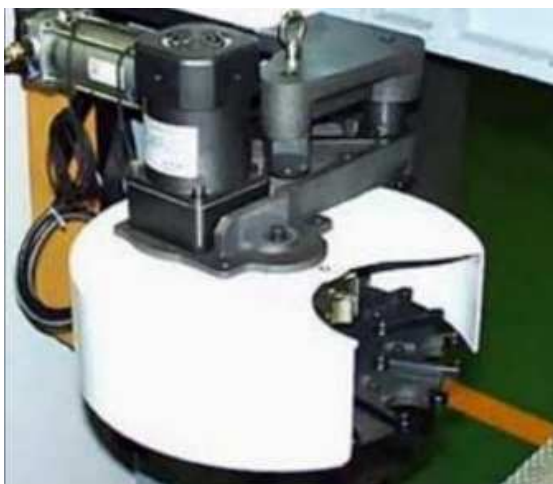
Obr. 7, 8 – Bubnový (vlevo) a talířový zásobník firmy AENY [8]
