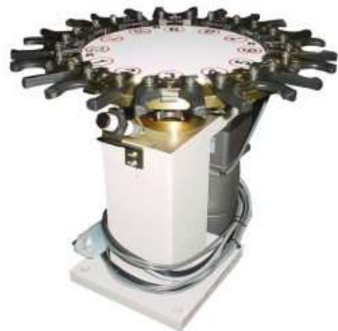
Obr. 7, 8 – Bubnový (vlevo) a talířový zásobník firmy AENY [8]
