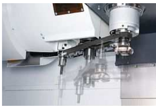
Obr. 14 – Bubnový zásobník nástrojů s výměnnou rukou [10]
