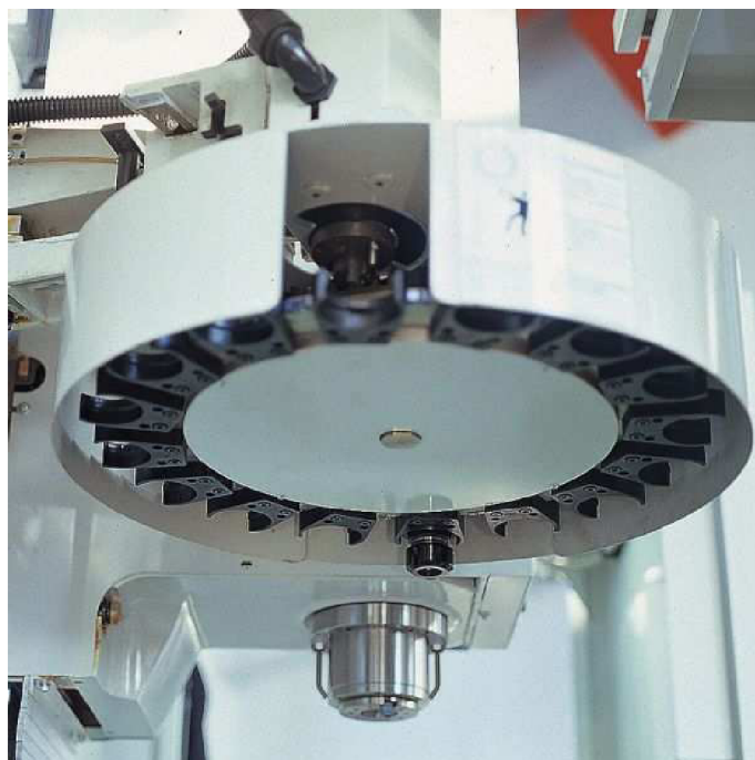
Obr. 9 - Zásobník nástrojů dodávaný ke stroji VMF 610 [9]
