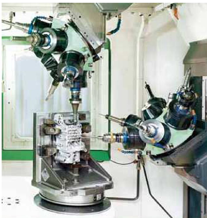
Obr. 6 – Použití více nástrojových hlav [6]
