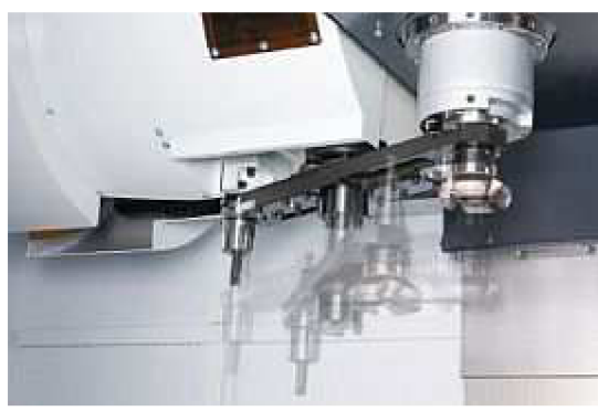
Obr. 14 – Bubnový zásobník nástrojů s výměnnou rukou [10]
