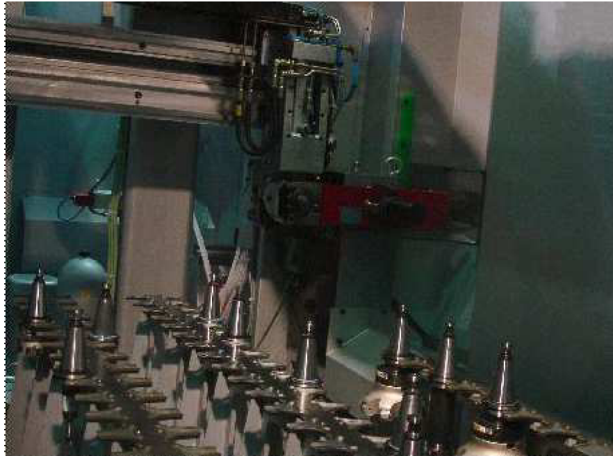
Obr. 20 – Regálový zásobník firmy Hüller Hille [16]
