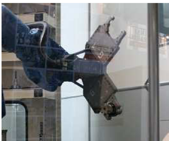
Obr. 22 Detail držáku nástrojů u průmyslového robota [16]
