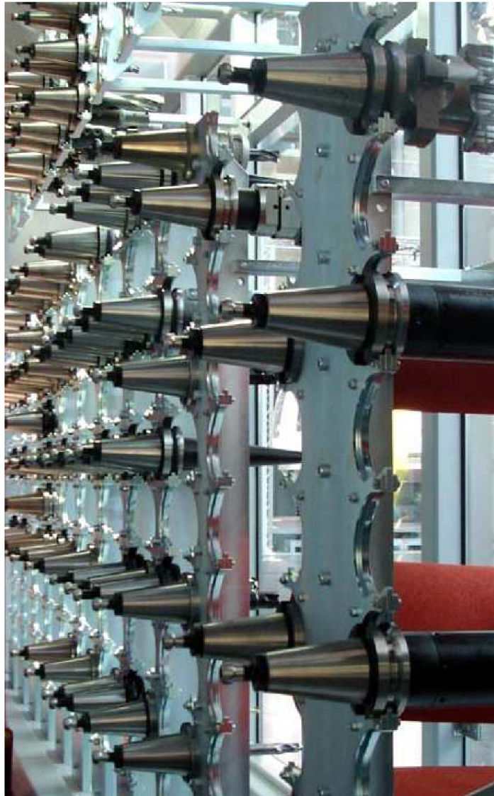
Obr. 23 – Regálový zásobník firmy Toyota [15]
