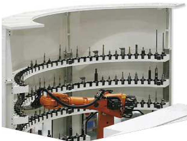
Obr.21. Regálový zásobník fy DEMMELER [3]
