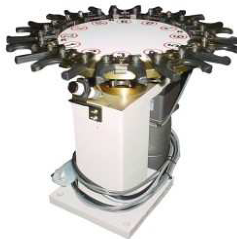
Obr. 7, 8 – Bubnový (vlevo) a talířový zásobník firmy AENY [8]
