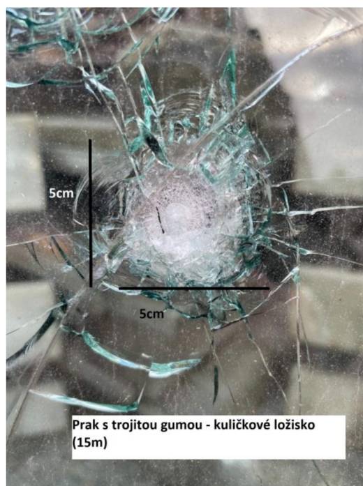
Obrázek 43 Částečná penetrace čelního skla Citroen Jumpy kuličkou z kuličkového ložiska č. 4 - vlastní zdroj
