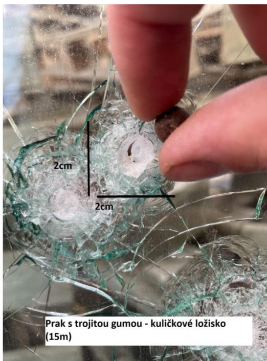
Obrázek 41 Penetrace čelního skla Citroen Jumpy kuličkou z kuličkového ložiska č. 2 - vlastní zdroj
