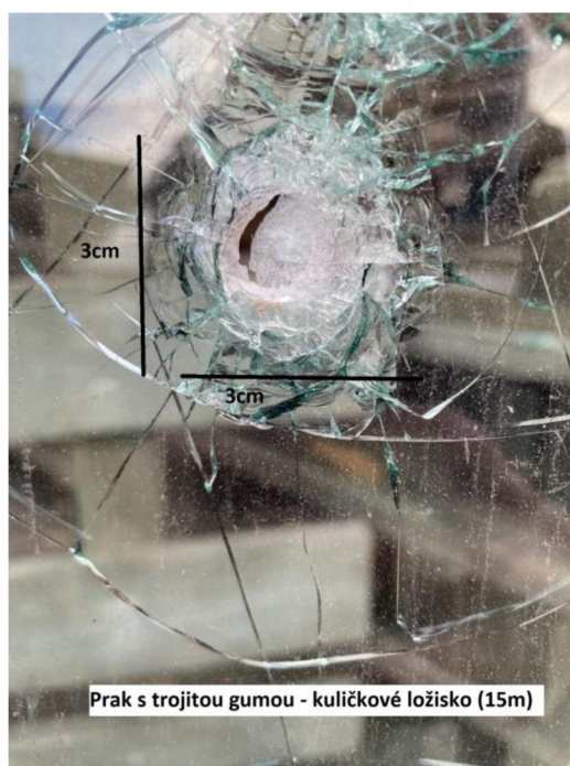
Obrázek 40 Penetrace čelního skla Citroen Jumpy kuličkou z kuličkového ložiska - vlastní zdroj
