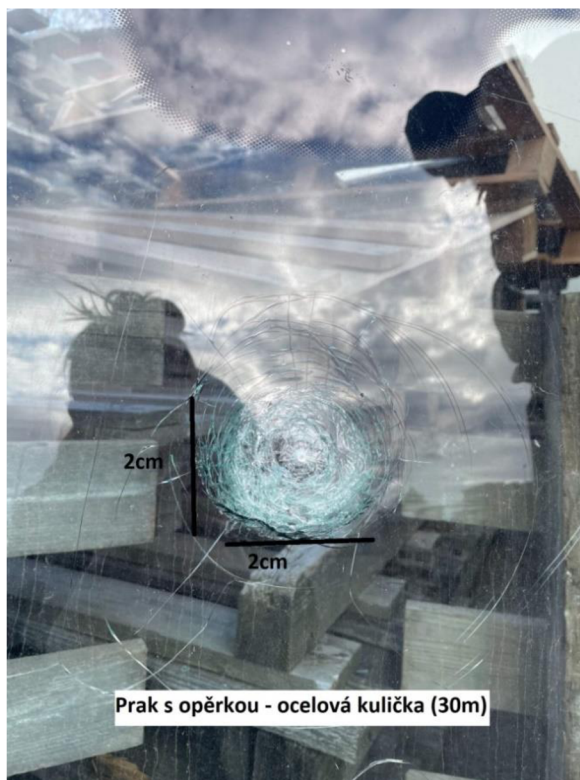
Obrázek 53 Zásah čelního skla Peugeot 307 - vlastní zdroj
