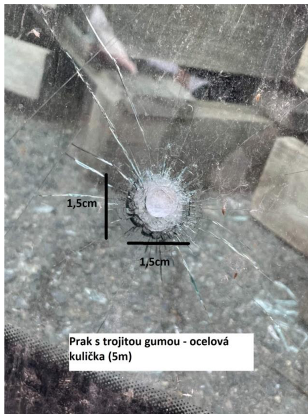
Obrázek 36 Zásah čelního skla Peugeot 307 č. 3 - vlastní zdroj
