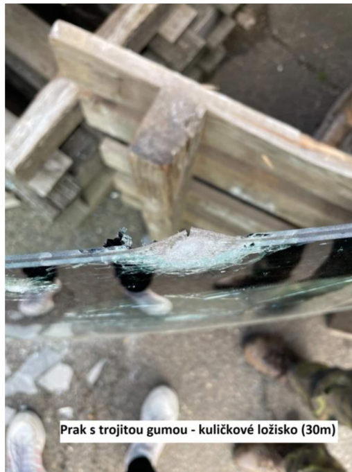
Obrázek 38 Zásah čelního skla Citroen Jumpy kuličkou z kuličkového ložiska - detail horní části - vlastní zdroj
