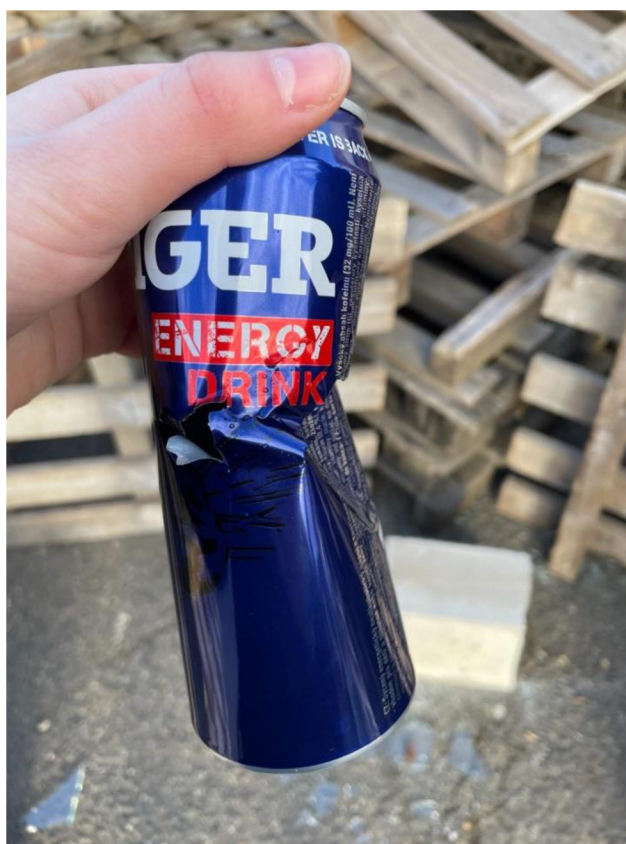
Obrázek 48 Penetrace plechové nádoby kuličkou z kuličkového ložiska - vlastní zdroj
