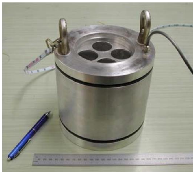
Obr. 4-5: CLS, Kalibrační zdroj UV světla [32]
