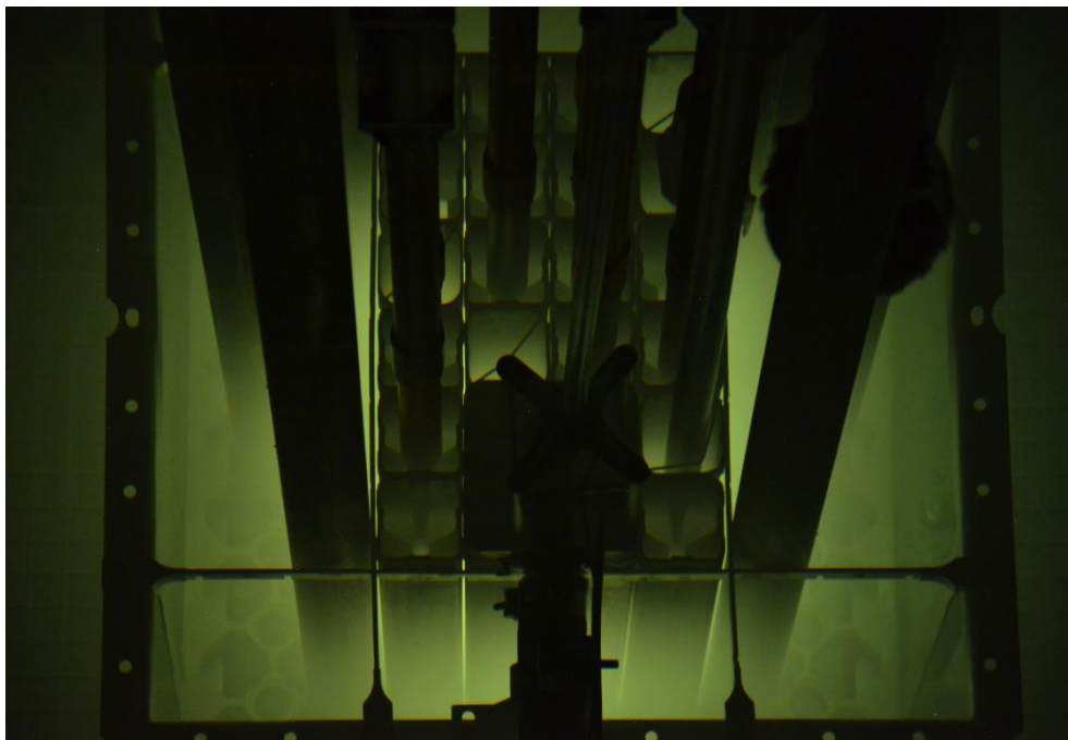
Obr. 7-7: Snímek Čerenkovova záření v aktivní zóně jaderného reaktoru VR-1 pořízený se speciálním filtrem.
