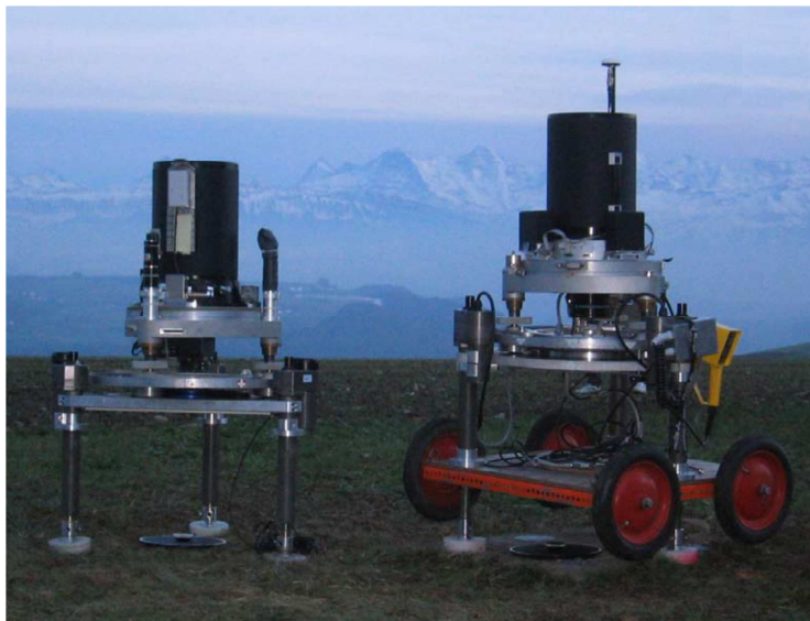
Obr. č.6 Digitální zenitové kamerové systémy TZK2-D (vpravo) a DIADEM (vlevo) [1]
