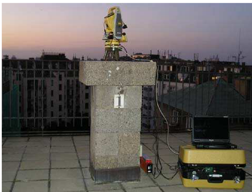
Obr.č.8 MAAS-1 při měření na terase FAST, VUT v Brně
