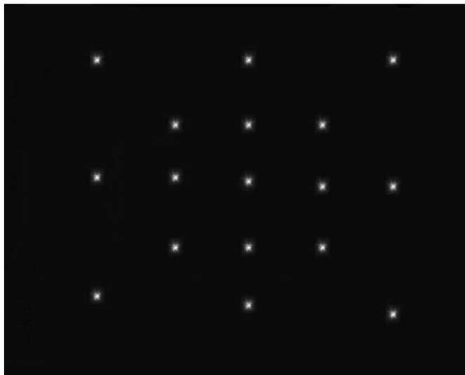
Obr.č.13 Snímané body pro kalibraci kamery
