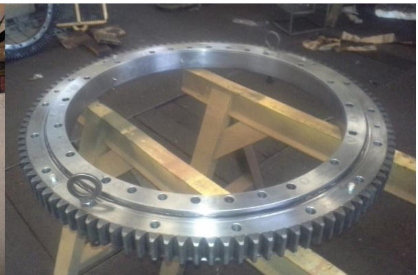
Obr. 8 - Nové velkorozměrové otočové ložisko [5]
