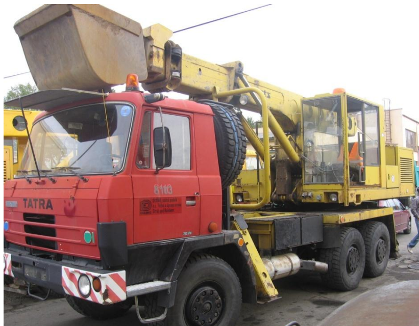
Obr. 22 - Teleskopické rypadlo UDS 114 před opravou [5]
