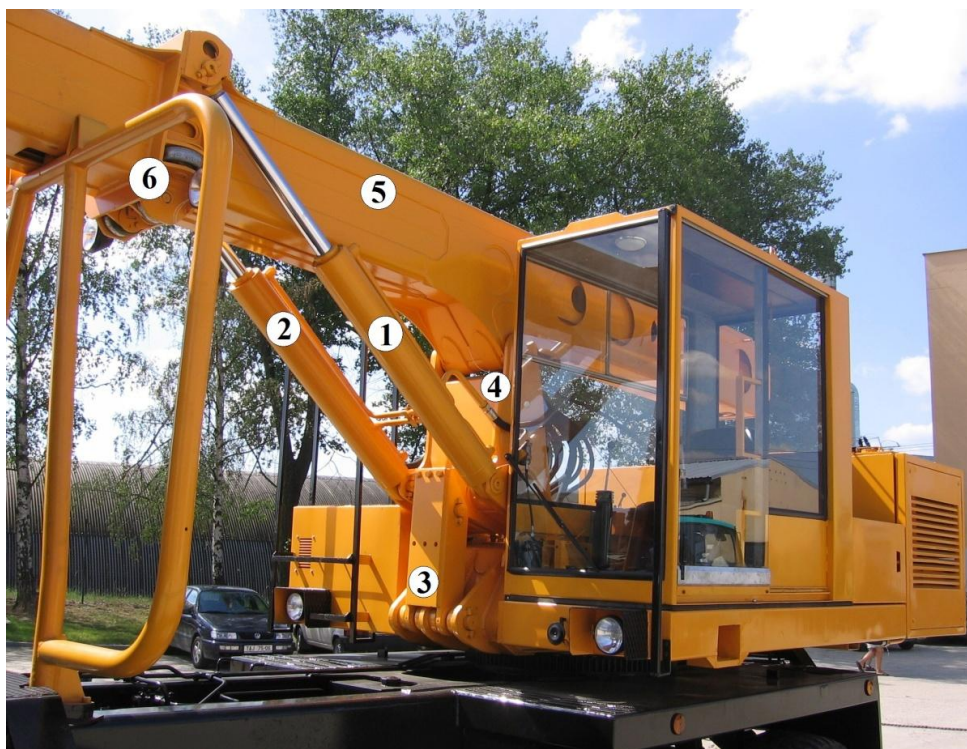
Obr. 13 - Detail nástavby teleskopického rypadla UDS 114[5]
