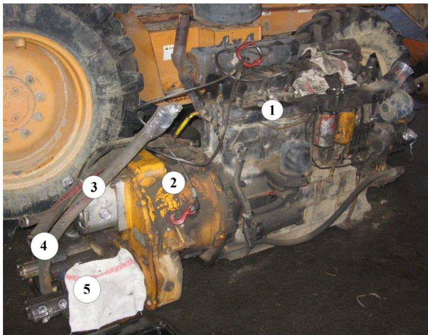
Obr. 9 - Demontovaný agregát teleskopického rypadla UDS 114 [5]
