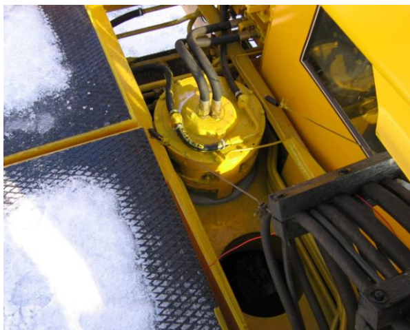
Obr. 14 - Hydromotor otoče HMB 630 U na teleskopickém rypadle UDS 114 [5]
