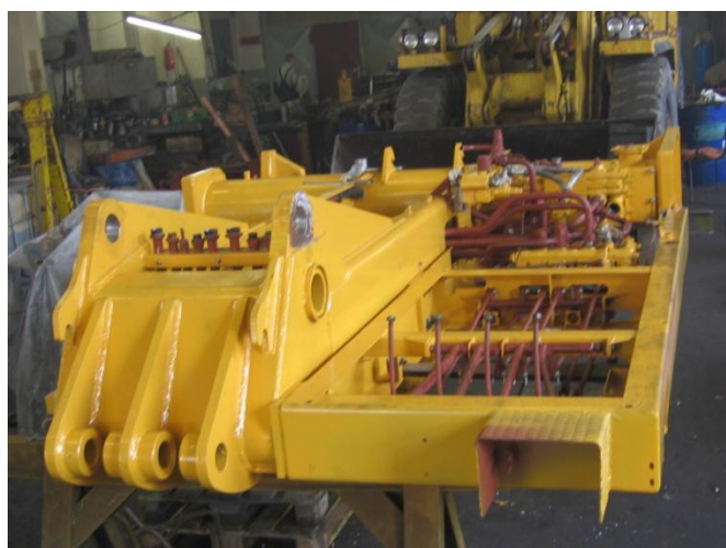
Obr. 16 - Horní rám UDS 114 v průběhu opravy [5]
