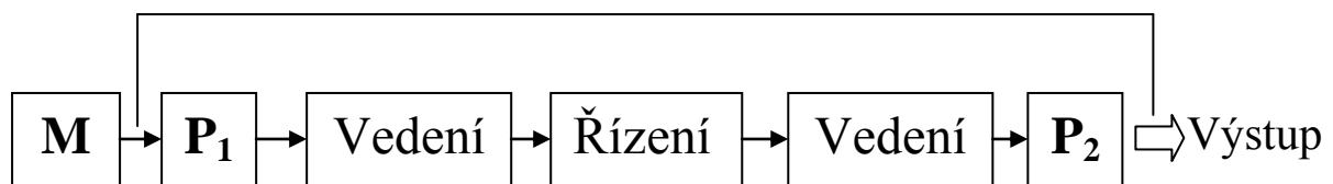
Obr. 6 - Blokové schéma funkce hydraulického obvodu
