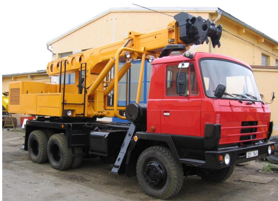
Obr. 27: Teleskopické rypadlo UDS 114 po provedené opravě [5]
