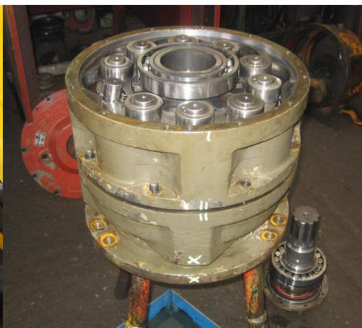
Obr. 15 - Demontovaný hydromotor otoče HMB 630 U [5]
