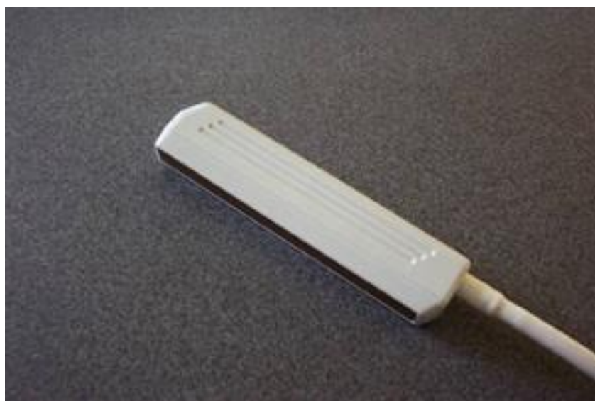
Obrázek 4 Ultrazvukový převodník obsahující malé krystaly, které emitují a zachycují zvukové vlny.
