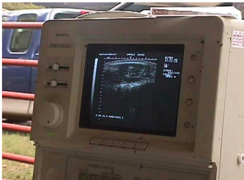
Obrázek 3 Ultrazvukový přístroj zobrazuje odražené vlny jako obrázek na obrazovce. Toto je obraz vysokého roštěnce.
