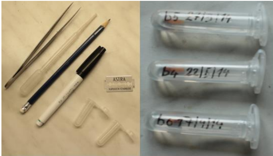
Obrázek 9. Vybavení pro označení příčných ploch vzorků, jejich zakrácení a uchování vzorků náhradních
