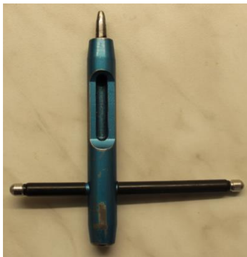
Obrázek 8. Nástroj sloužící k odběru vzorků ze struktury stromů zvaný Trephor
