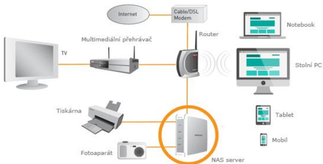
Obrázek č. 10 – schéma fungování NAS
