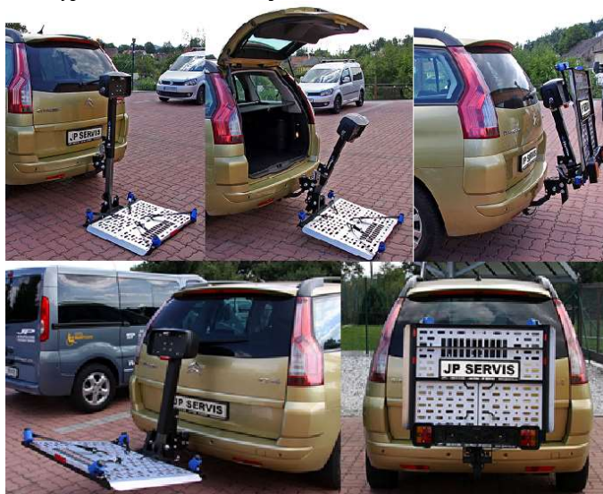
Obr. 41 Zařízení pro přepravu elektrického invalidního vozíku typ Harmer AL300 Zdroj: Oficiální webové stránky dodavatele http://www.jpservis.eu (2016)
