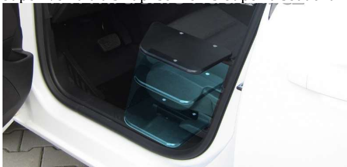
Obr. 28 Přesedací deska s elektrickým zdvihem Josef Hurt – ruční ovládání Zdroj: Oficiální webové stránky dodavatele http://www.rucniovladani.cz (2016)
