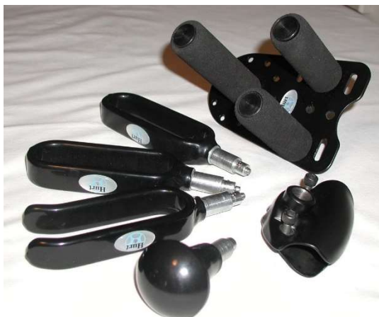
Obr. 20 Nástavce na volant – jednotlivé typy + pevná část nástavce Zdroj: Archiv firmy Josef Hurt – ruční ovládání (2016)
