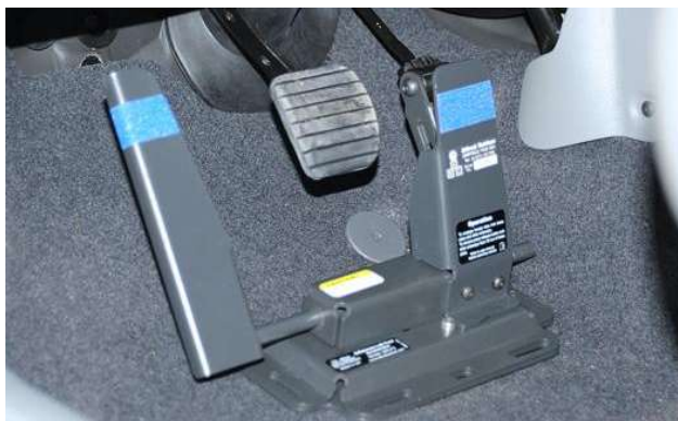
Obr. 17 Plyn na levou nohu API CZ s.r.o.
