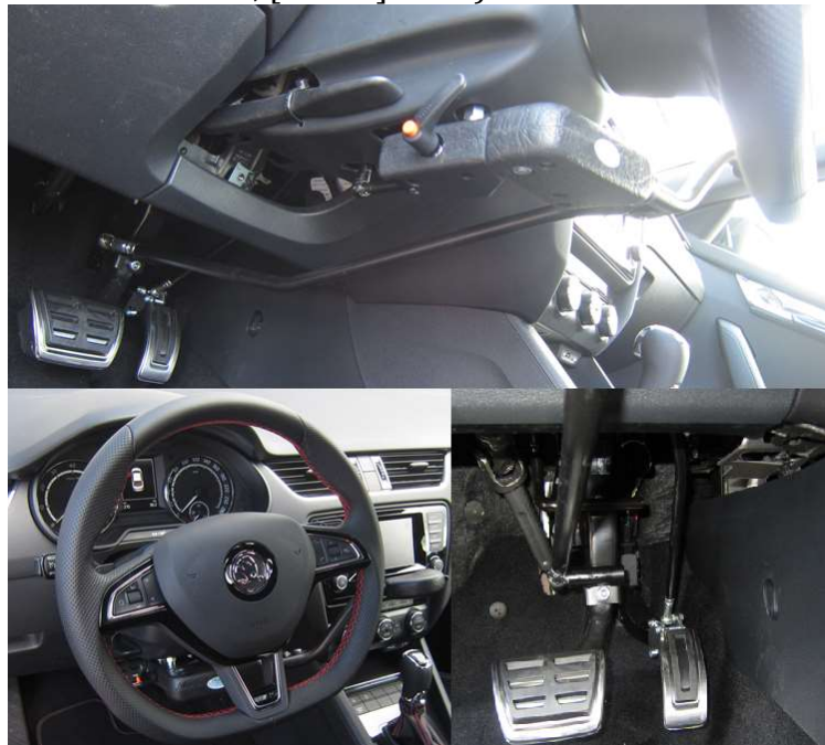
Obr. 48 Ruční ovládání brzdy a plynu na pravou ruku typ MERO Zdroj: Archiv firmy Josef Hurt – ruční ovládání (2016)
