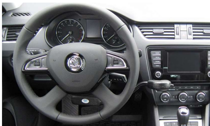
Obr. 5 Mechanické ovládání brzdy a plynu na jedné páce ve verzi s automatickou převodovkou Zdroj: Oficiální webové stránky http://www.skoda-auto.cz (2016)
