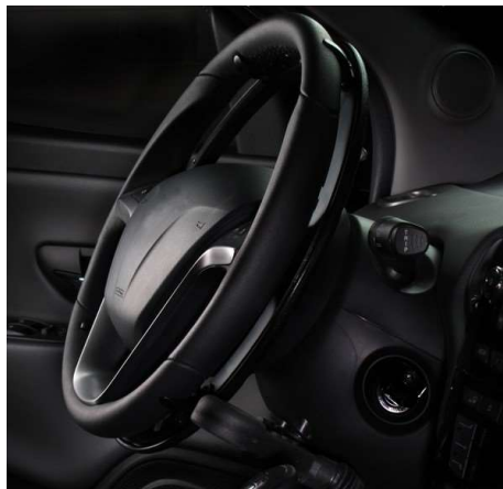
Obr. 10 Elektronický kruhový plyn Ghost 916R firmy Quidosimplex umístěný pod volantem Zdroj: Oficiální webové stránky výrobce http://www.guidosimplex.it (2016)
