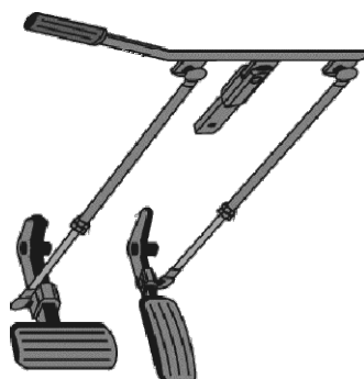
Obr. 6 Schéma ovládání plynu k sobě, brzdy od sebe Zdroj: Oficiální webové stránky http://www.mikes-autotrend.cz (2009)
