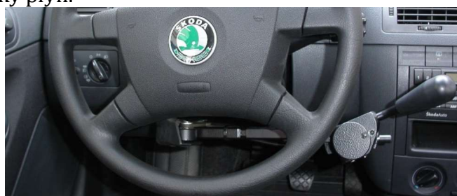
Obr. 7 Ruční ovládání Europe Zdroj: Oficiální webové stránky http://www.jenca.cz (2016)
