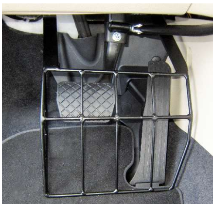
Obr. 49 Kryt pedálů Josef Hurt – ruční ovládání Zdroj: Archiv firmy Josef Hurt – ruční ovládání (2016)
