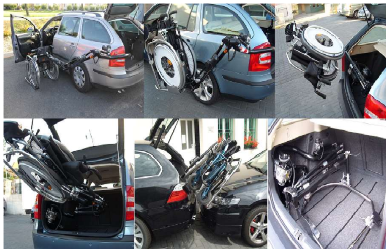
Obr. 32 Nakládací robot typ Robot 201 na dálkové ovládnání - uložení mechanického invalidního vozíků do zavazadlového prostoru automobilu
