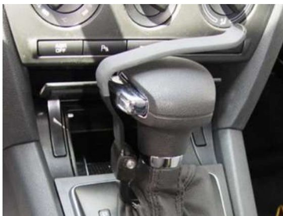
Obr. 21 Nástavec řadící páky automaticky řazené převodovky s odjištěním jistícího tlačítka řadící páky Zdroj: Archiv firmy Josef Hurt – ruční ovládání (2016)
