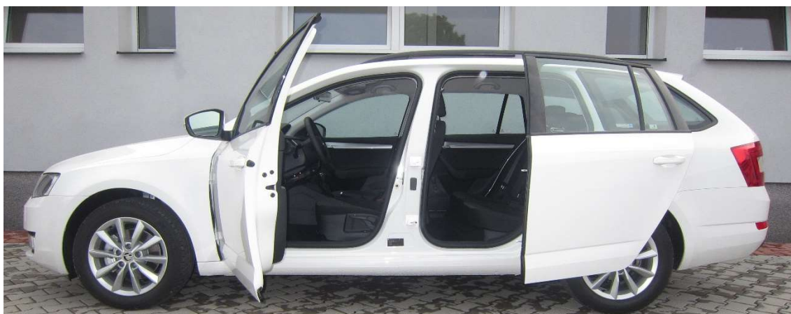
Obr. 31 Mechanicky/elektricky posuvné dveře Josef Hurt – ruční ovládání Zdroj: Archiv firmy Josef Hurt – ruční ovládání (2016)
