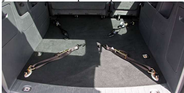
Obr. 37 Kotvící zařízení invalidního vozíku – ráčnové Zdroj: Oficiální webové stránky dodavatele http://www.jpservis.eu (2016)
