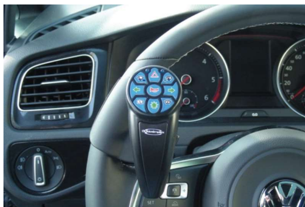
Obr. 18 Infraovladač sdružených přepínačů výrobce Guidosimplex Zdroj: Oficiální webové stránky dodavatele http://www.iroa.cz (2016)
