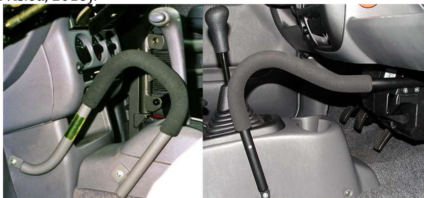
Obr. 46 Opěrka nohy ze strany řidiče a opěrka nohy ze strany spolujezdce Zdroj: Oficiální webové stránky dodavatele http://www.jpservis.eu (2016)
