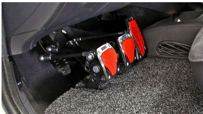
Obr. 16 Prodloužení pedálů v kombinaci se zvýšenou podlahou - Jan Píbal – JP servis Zdroj: Oficiální webové stránky dodavatele http://www.jpservis.eu (2016)
