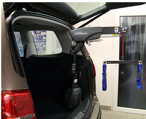
Obr. 33 Jeřábek na zvedání vozíku Carolift
