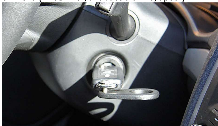
Obr. 23 Nástavec na klíč - "kvadro" pro vůz Škoda Octavia Zdroj: Oficiální webové stránky dodavatele http://www.jpsservis.eu (2016)
