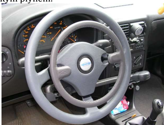
Obr. 9 Ruční ovládání Quidosimplex typ 907/906 brzda a mechanický plyn kruhu Zdroj: Oficiální webové stránky dodavatele http://www.jenca.cz (2016)
