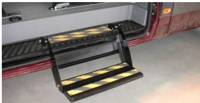
Obr. 30 Nástupní schůdek do automobilu
