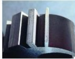
Řezání s ProgressJet Čas cyklu: 6'27" Přesnost (úkos): 0,038mm
