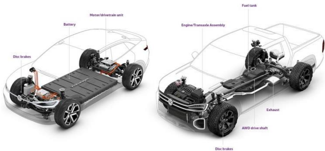
Obrázek 3 Rozdíl mezi platformou MEB (vlevo) a MQB (vpravo), (29)
