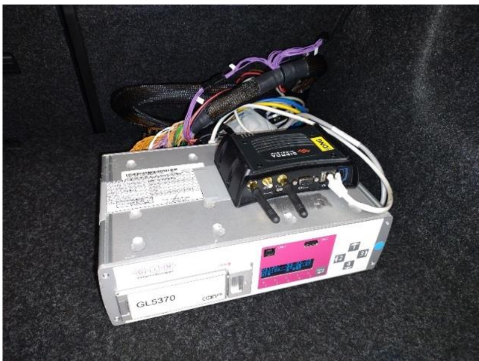
Obrázek 24 Datalogger GL 5370 připojení k sběrnici Enyaqu, (vlastní zdroj)
