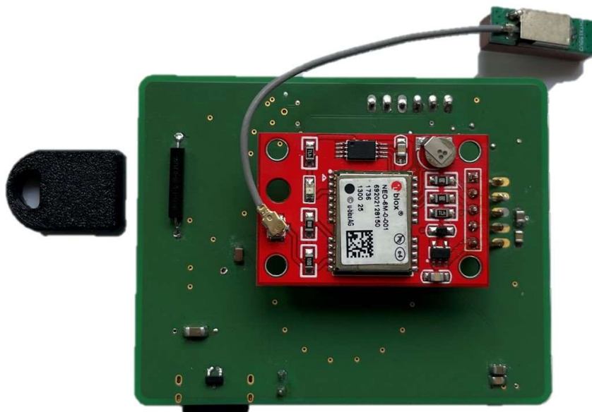
Obr 3.13: Zhotovená DPS Vysílače (vypínací magnet vlevo) - zadní strana
