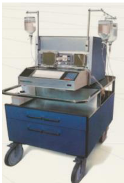
Obrázek 1: První „přenosný“ nitrozžilní systém monitorace a podávání inzulínu (Brink 2022).
